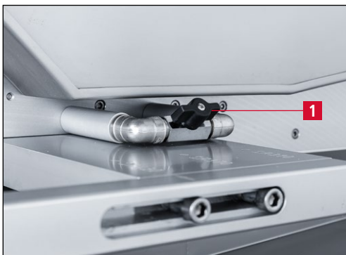
Bild 3-5 Kühlmitteldosierung für Nass-Schleifband
