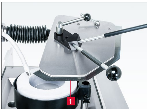
Bild 7-82 Messerposition auf der Schleifscheibe
