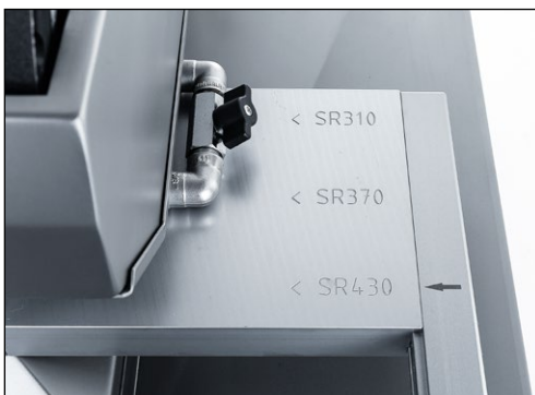
Bild 7-28 Eingestellte Position der Schleif- und Poliereinrichtung
