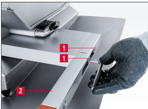
Bild 7-96 M 10 Schrauben lösen
