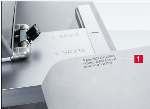
Bild 7-95 Angezeigter Schleifradius auf der Schleifplatte SP 107
