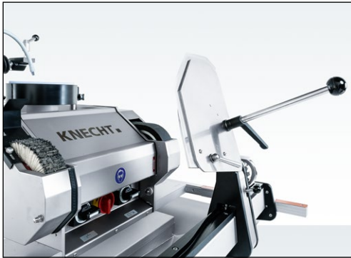
Bild 7-130 Messer außerhalb des Polierbereichs in gesicherter Position
