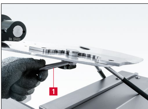
Bild 7-18 Messer auf Schleifplatte arretieren
