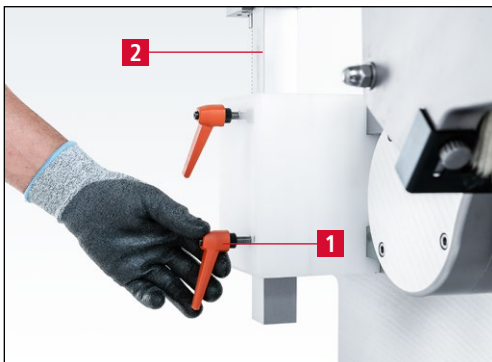
Bild 7-20 Messer auf Schleifscheibenmitte einstellen
