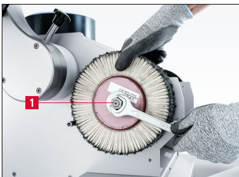
Bild 7-152 Untere Lamellenbürste wechseln
