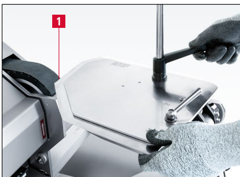
Bild 7-114 Messer am Schleifband ausrichten
