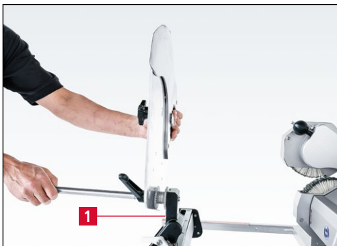
Bild 7-52 Kuttermesser zurückgeklappt und gesichert
