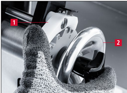
Bild 7-45 Schleifeinrichtung in die Einstellposition „0“ bringen
