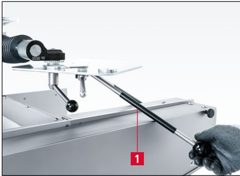
Bild 7-78 Schleifplatte nach hinten schwenken
