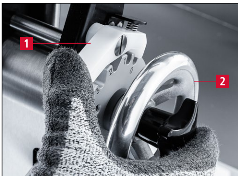
Bild 7-110 Schleifeinrichtung in die Einstellposition „0“ bringen
