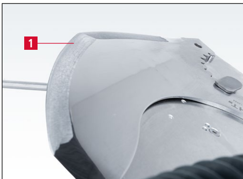
Bild 7-27 Ballig vorgeschliffenes Kuttermesser
