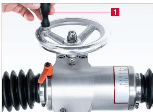
Bild 7-91 Schleifwinkel reduzieren (ballig schleifen)
