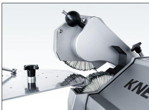
Bild 7-58 Distanz zwischen Lamellenbürsten ca. 20 mm
