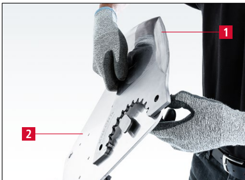
Bild 7-41 Messer auf Schweißplatte aufspannen
