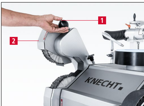
Bild 7-137 Obere Poliereinheit in Ruheposition
