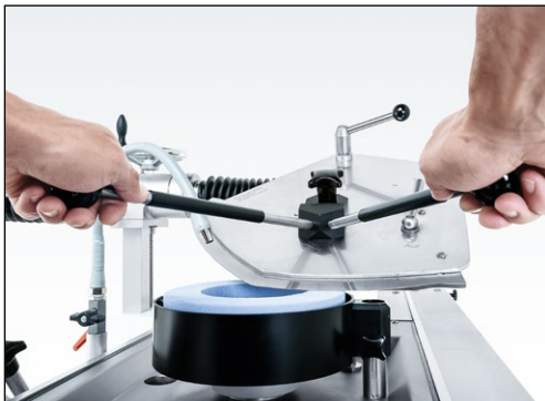
Bild 7-26 Kuttermesser auf nächstes Schneidensegment schwenken und schleifen
