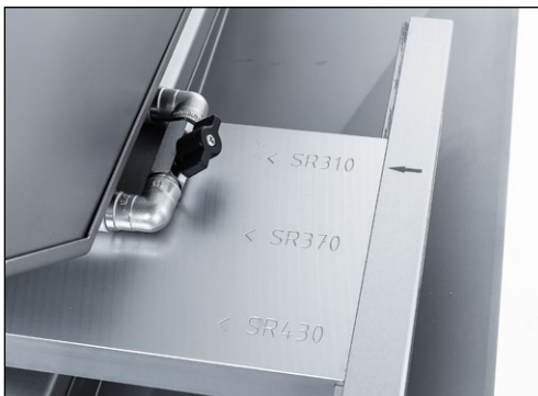
Bild 7-94 Eingestellte Position der Schleif- und Poliereinrichtung
