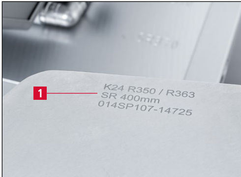
Bild 7-29 Angezeigter Schleifradius auf der Schleifplatte SP 107
