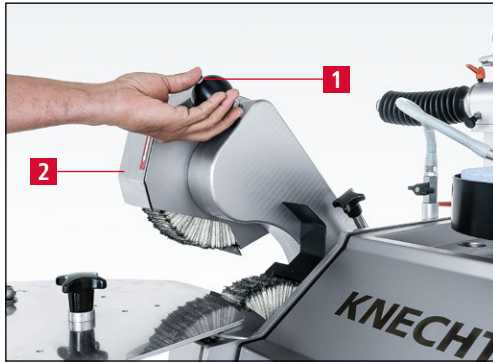
Bild 7-60 Obere Poliereinheit nach oben schwenken
