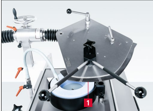
Bild 7-19 Messerposition auf der Schleifscheibe
