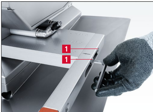
Bild 7-30 M10 Schrauben lösen
