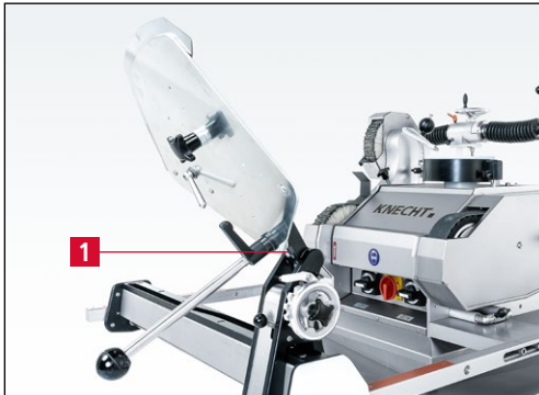
Bild 7-63 Messer außerhalb des Polierbereichs in gesicherter Position
