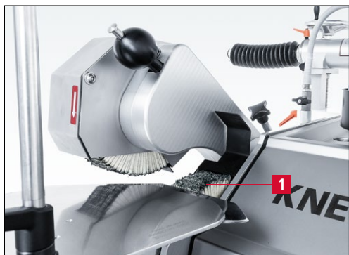
Bild 7-124 Messer liegt auf der Lamellenbürste
