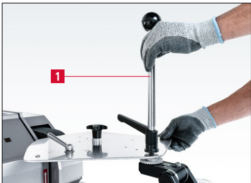
Bild 7-38 Schleifhebel leicht festziehen
