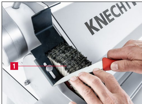
Bild 7-138 Handmesser entgraten und polieren
