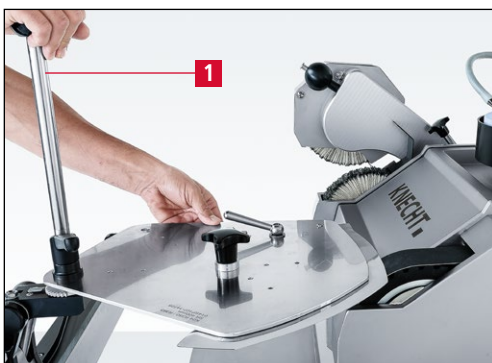
Bild 7-68 Kuttermesser auf nächstes Schneidensegment schwenken und schleifen
