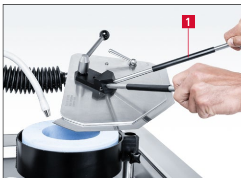
Bild 7-90 Lineare Kuttermesser schleifen
