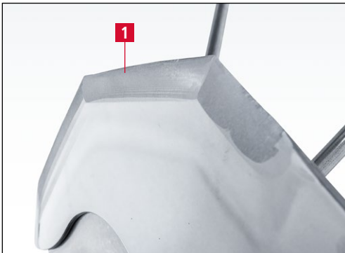
Bild 7-93 Ballig vorgeschliffenes Kuttermesser
