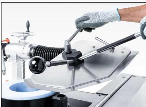
Bild 7-85 Messer auf der Schleifscheibe ausrichten
