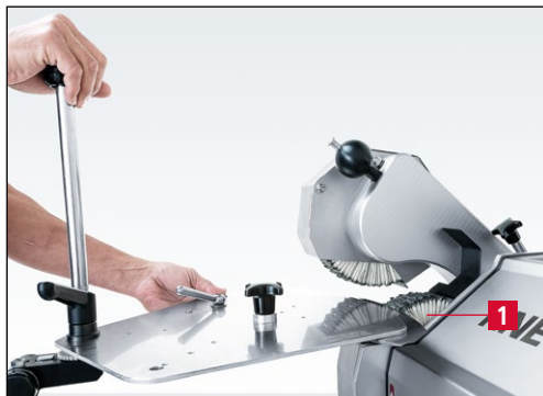
Bild 7-57 Messer liegt auf der Lamellenbürste
