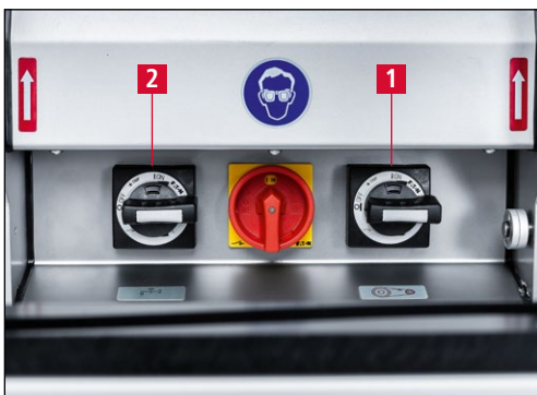
Bild 7-116 Schleifmotor und Kühlmittel-einrichtung einschalten
