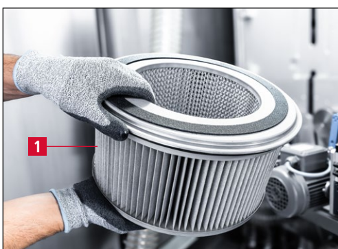
Imagen 9-5 Limpiar el cartucho filtrante
