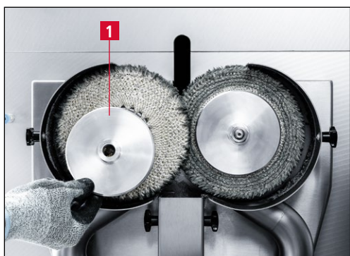
Imagen 7-25 Retirar el disco de brida
