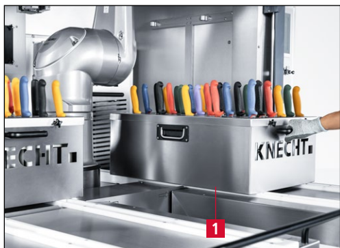
Imagen 7-4 Inserción de los cartuchos de cuchillos en la afiladora
