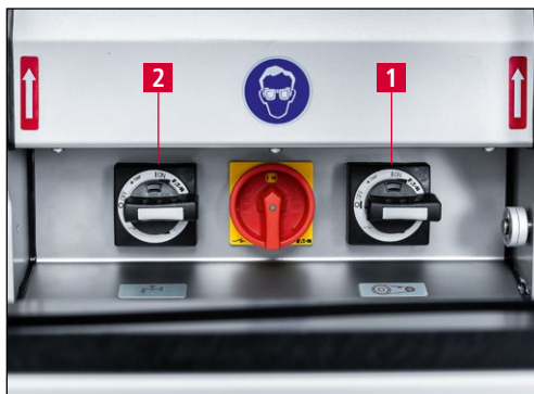
7-12. ábra A köszörűmotor és a hűtőfolyadék-berendezés bekapcsolása
