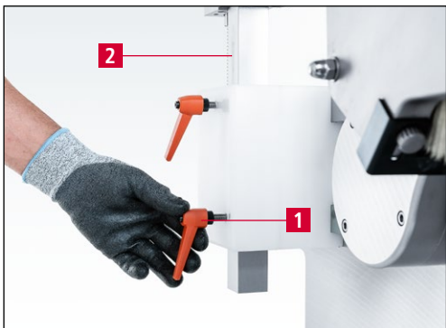
7-8. ábra A körkés elhelyezése a köszörűkorongon
