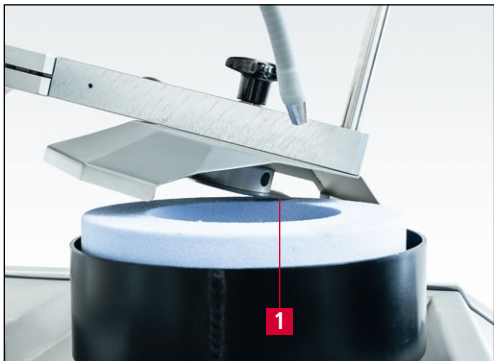
7-7. ábra A körkés elhelyezése a köszörűkorongon
