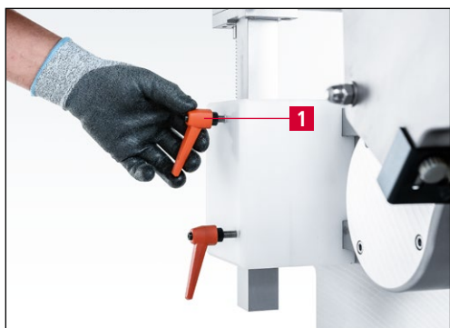
7-23. ábra A szorítókar meglazítása
