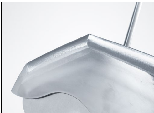
Obrázok 7-26 Konvexne predbrúsený nôž na rezanie
