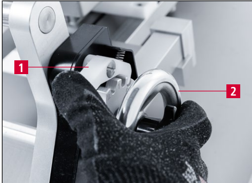
Obrázok 9-40 Nastavenie brúsneho zariadenia do nastavovacej polohy „0“
