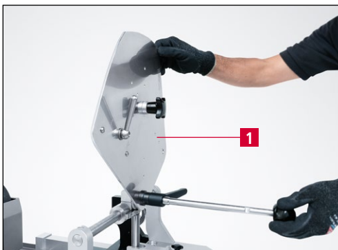
Obrázok 9-35 Otočenie brúsnej dosky dozadu do poistky proti otáčaniu
