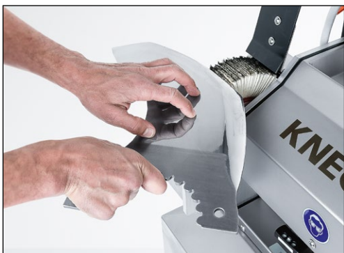
Obrázok 9-50 Odstránenie ostrapkov a leštenie noža na rezanie na lamelovej kefe
