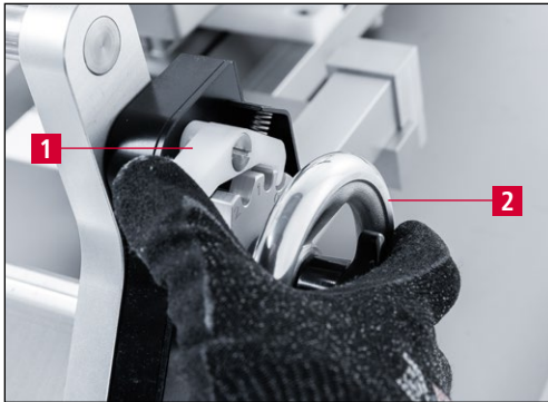
Obrázok 9-13 Nastavenie brúsneho zariadenia do nastavovacej polohy „0“
