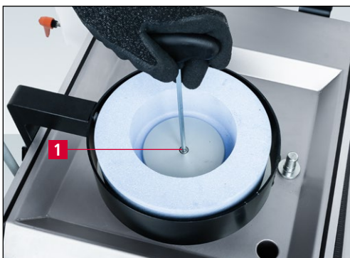
Obrázok 7-12 Výmena brúsneho kotúča
