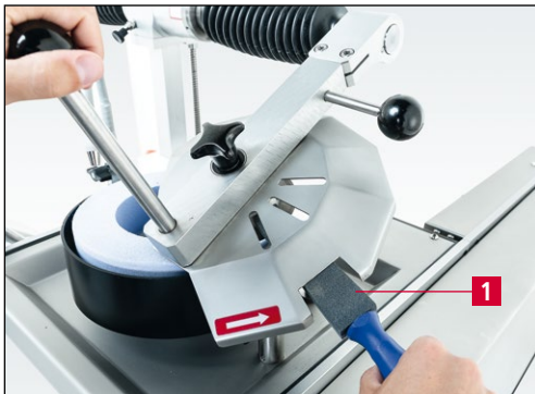
7-14. ábra A körkés sorjátlanítása
