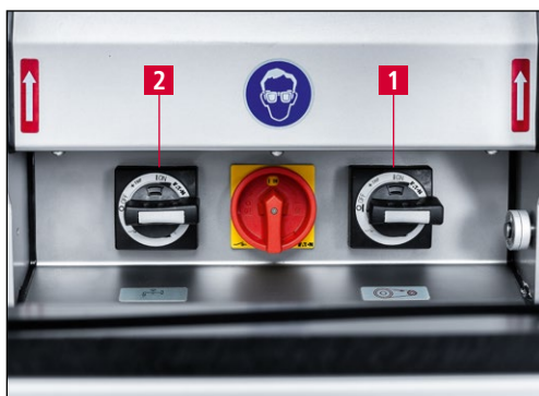
7-12. ábra A köszörűmotor és a hűtőfolyadék-berendezés bekapcsolása
