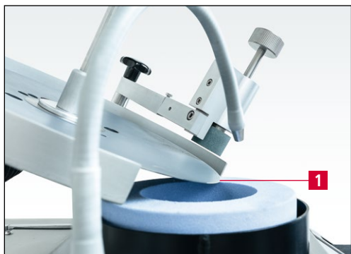
7-21. ábra A körkés elhelyezése a köszörűkorongon
