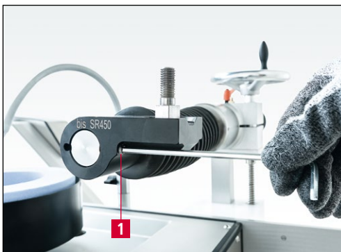
6-2. ábra A menetes szárok meglazítása
