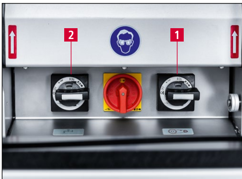
7-25. ábra A köszörűmotor és a hűtőfolyadék-berendezés bekapcsolása
