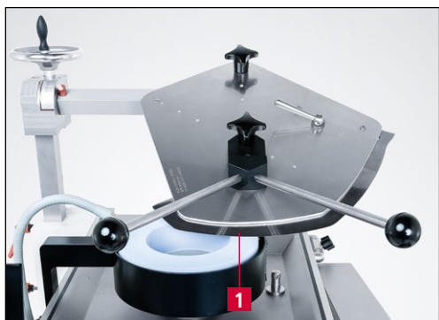
Figura 7-13 Posizione del coltello sulla mola
