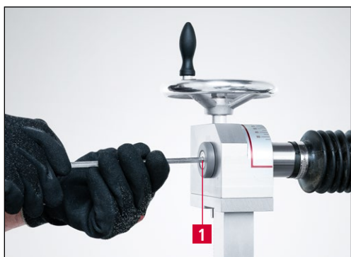
Figura 6-1 Rimozione del braccio di affilatura universale HV 203
