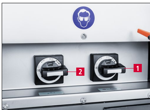
Figura 7-17 Accendere l'affilatrice e il sistema di raffreddamento
