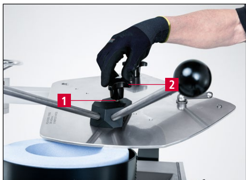
Figura 7-8 Montare la leva di affilatura sulla piastra di affilatura
