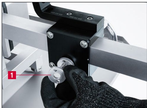
Figura 9-1 Dischi distanziatori per la regolazione dell'angolo di affilatura
