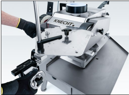
Figura 9-14 Spostare l'unità di levigatura verso il nastro abrasivo
