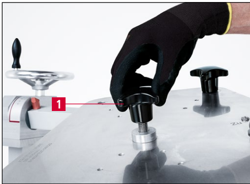
Figura 7-6 Rimuovere l'impugnatura a croce
