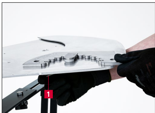
Figura 7-12 Bloccare il coltello sulla piastra di affilatura
