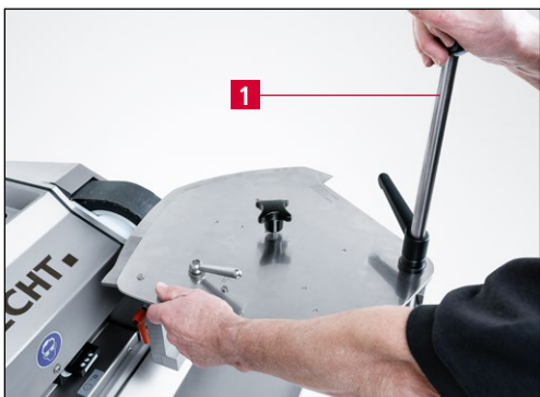
Figura 9-21 Ruotare il coltello da cutter verso il segmento tagliente successivo e affilarlo
