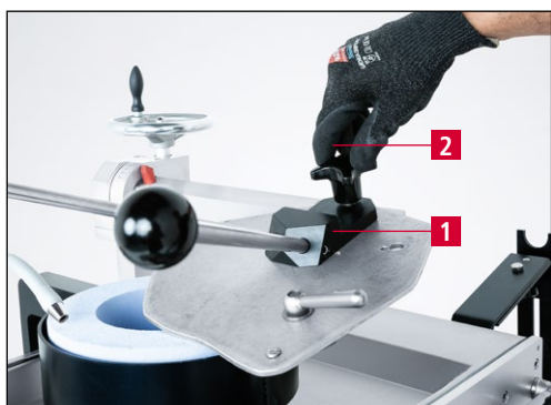
Figura 7-9 Montare la leva di affilatura sul perno di supporto
