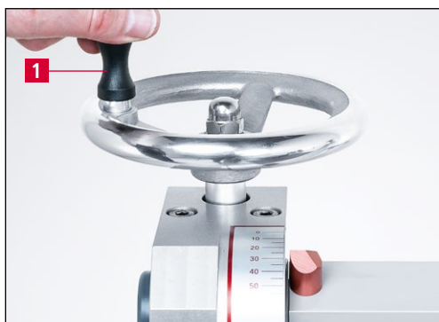
Figura 7-19 Ridurre l'angolo di affilatura (affilatura convessa)
