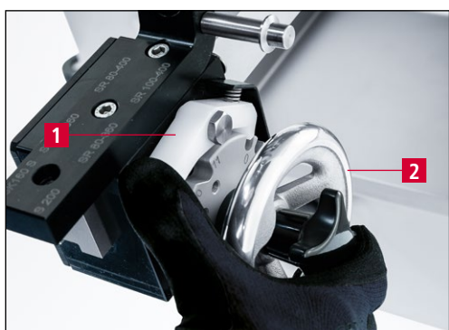
Figura 9-12 Portare l'unità di levigatura nella posizione di regolazione "0"
