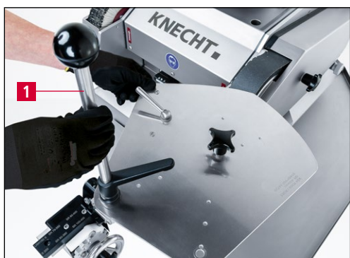
Figura 9-4 Serrare leggermente la leva di affilatura
