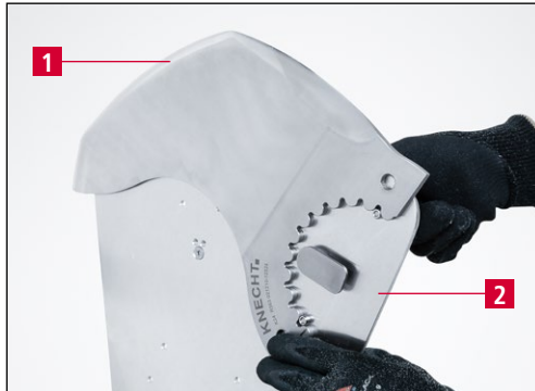
Figura 9-8 Fissare il coltello sulla piastra di affilatura
