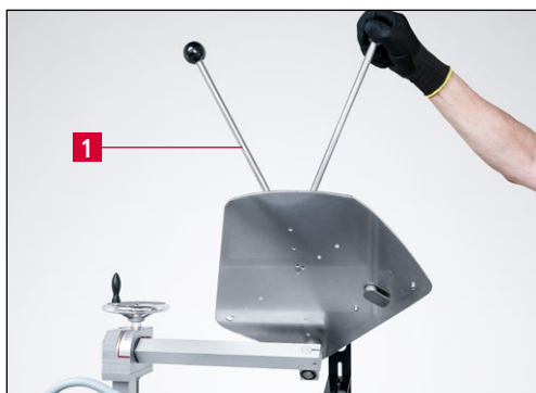
Figura 7-10 Ruotare all'indietro la piastra di affilatura
