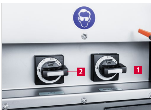
Figura 9-15 Accendere l'affilatrice e il sistema di raffreddamento
