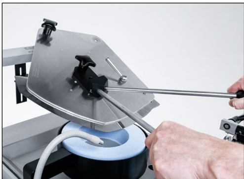
Figura 7-20 Ruotare il coltello da cutter verso il segmento tagliente successivo e affilarlo
