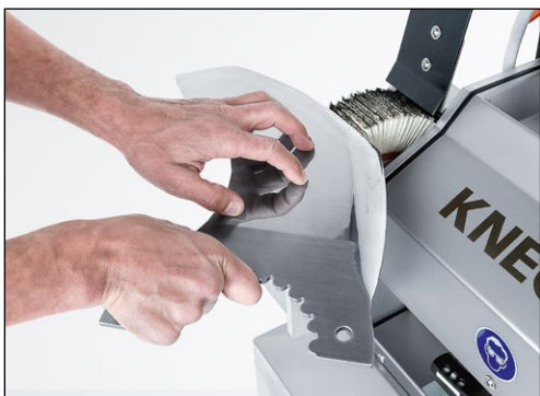
Figura 9-22 Rimuovere le bave e lucidare il coltello da cutter sulla spazzola lamellare
