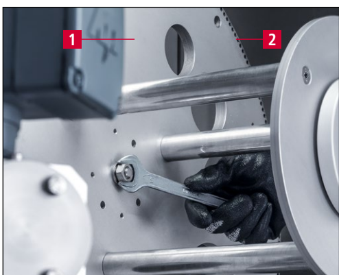
Afbeelding 7-5 Nokschijf SP 116 monteren
