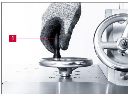
7-42 pav. Šerpetų šalinimo įrenginio aukščio reguliavimas
