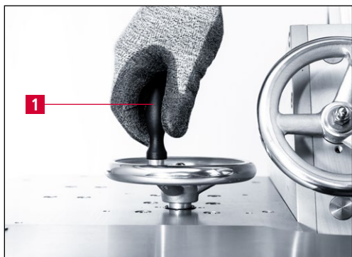
7-16 pav. Šerpetų šalinimo įrenginio aukščio reguliavimas
