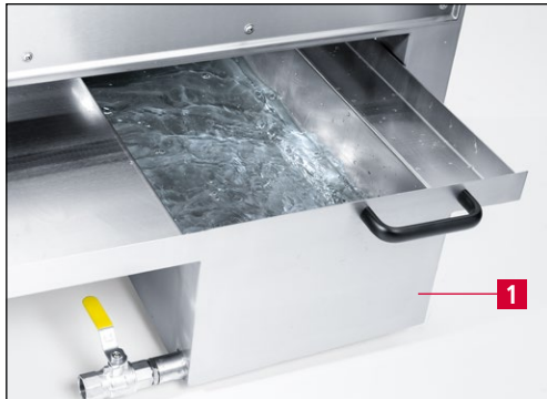
9-21 pav. Aušinimo skysčio keitimas
