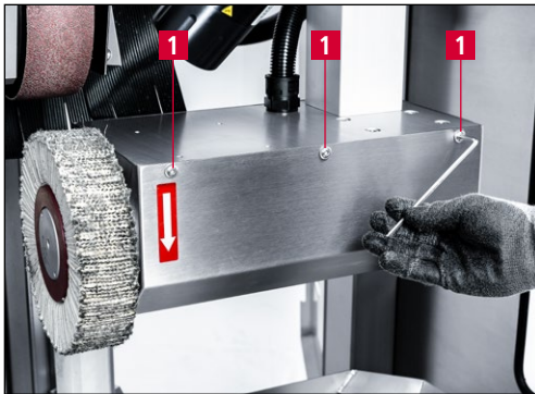
9-16 pav. Poliravimo įrenginio dangtelio nuėmimas
