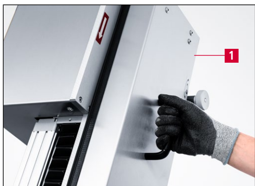
7-63 pav. Apsauginio juostos gaubto uždėjimas
