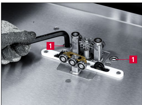
9-6 pav. Pakrepiamos plokštės atlaisvinimas
