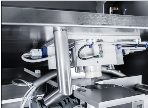
9-7 pav. Pakreipiamos plokštės išmontavimas
