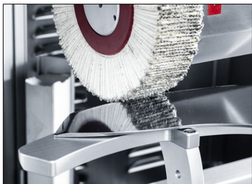
7-21 pav. Poliravimo šepetys priglundžia prie peilio
