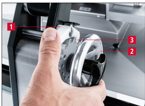
Figure 7-117 Amener l'affûteuse en position d'affûtage «1»
