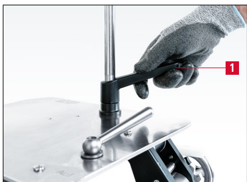
Figure 7-113 Desserrage du levier d'affûtage
