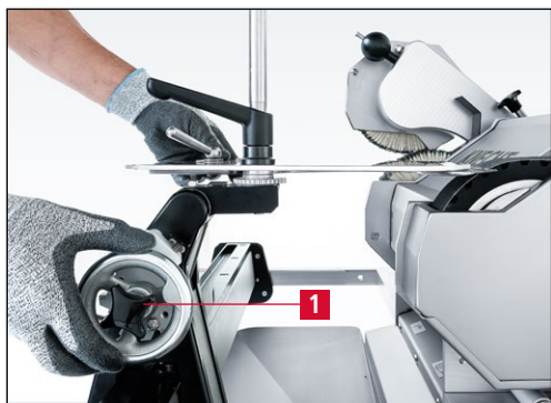
Figure 7-112 Déplacer l'affûteuse vers la bande d'affûtage
