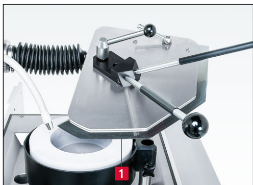
Figure 7-82 Position du couteau sur le disque d'affûtage
