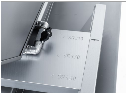
Figure 7-94 Position réglée de l'affûteuse-polisseuse
