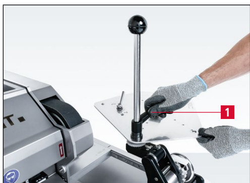
Figure 7-39 Réglage de la plage de pivotement
