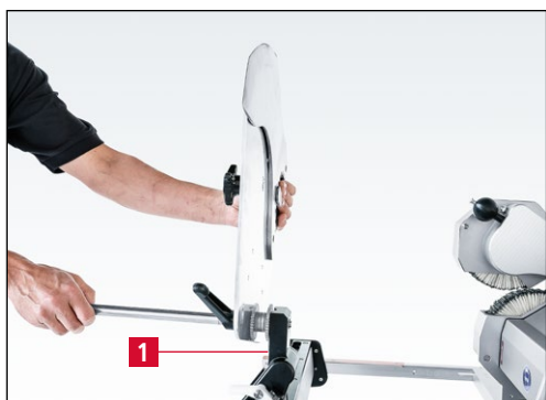
Figure 7-52 Couteau de cutter rabattu et sécurisé
