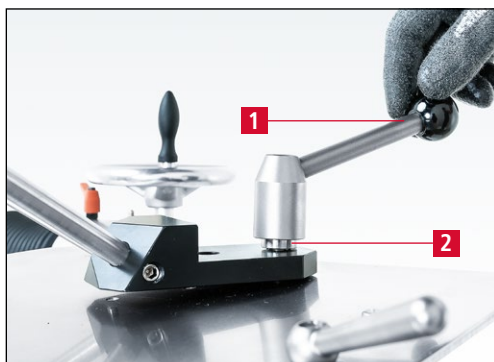
Figure 7-77 Fixer le plateau d'affûtage
