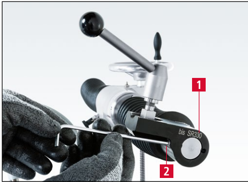
Figure 7-70 Montage de la tête porte-meule
