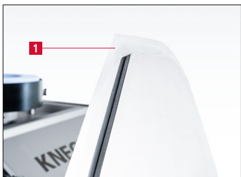
Figure 7-134 Contrôle de l'affûtage du couteau
