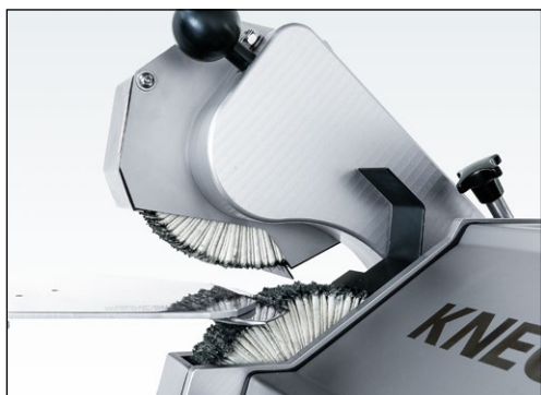
Figure 7-125 Distance entre les brosses à lamelles env. 20 mm
