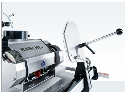
Figure 7-130 Couteau en dehors de la zone de polissage en position sécurisée
