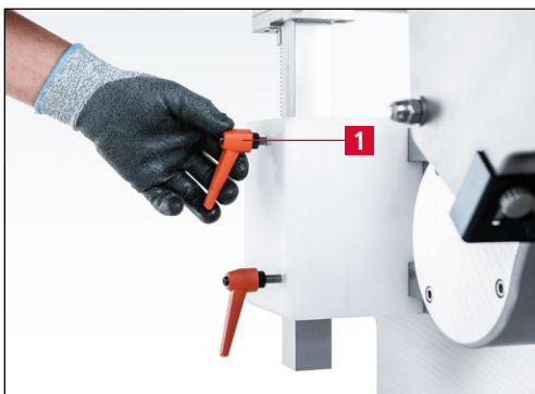
Figure 7-21 Desserrage du levier de blocage
