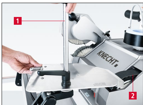
Figure 7-118 Ponçage des bavures
