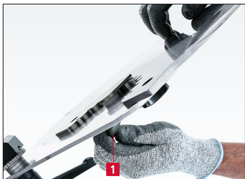
Figure 7-42 Blocage du couteau sur le plateau d'affûtage
