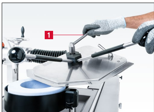
Figure 7-84 Desserrage du levier de serrage
