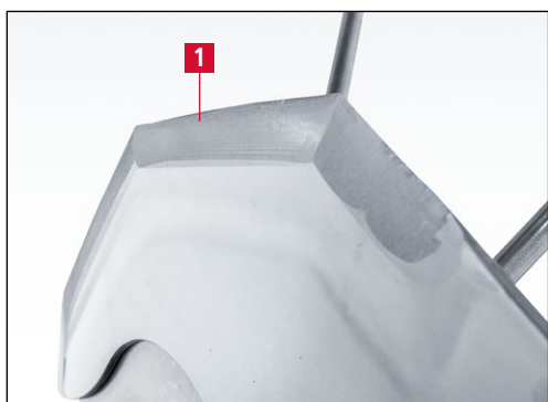
Figure 7-93 Préaffûtage bombé du couteau de cutter
