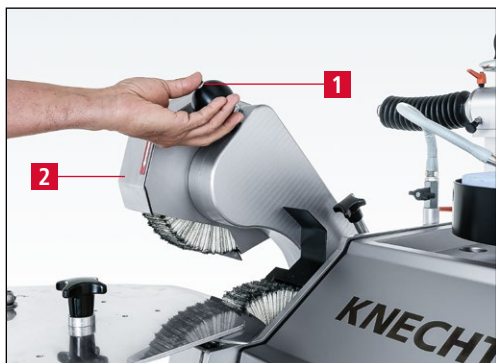
Figure 7-60 Faire pivoter l'unité de polissage supérieure vers le haut
