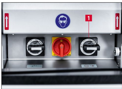
Figure 7-61 Mise en marche de l'affûteuse
