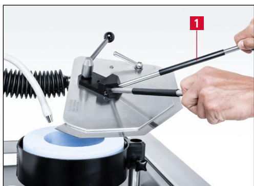
Figure 7-90 Affûtage des couteaux de cutter linéaires
