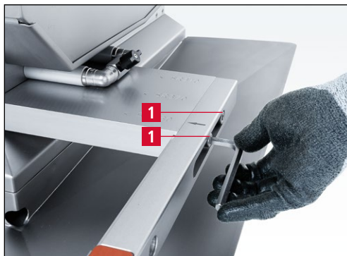
Figure 7-30 Desserrer les vis M10
