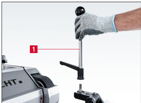
Figure 7-99 Retrait du levier d'affûtage
