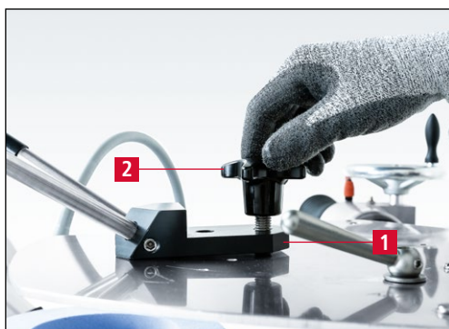
Figure 7-13 Montage du levier d'affûtage sur le plateau d'affûtage
