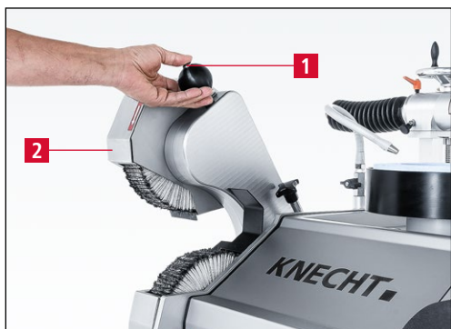
Figure 7-64 Mise en position de travail de l'unité de polissage supérieure
