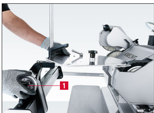
Figure 7-47 Déplacement de l'affûteuse vers la bande d'affûtage
