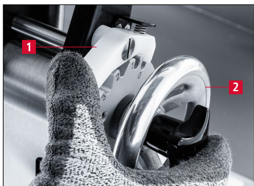
Figure 7-45 Rabattement de l'affûteuse en position «0»
