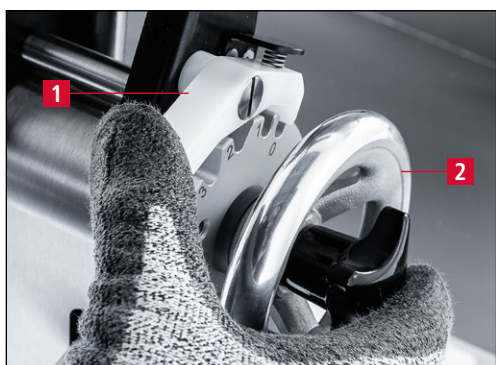
Figure 7-110 Rabattement de l'affûteuse à la position de réglage «0»
