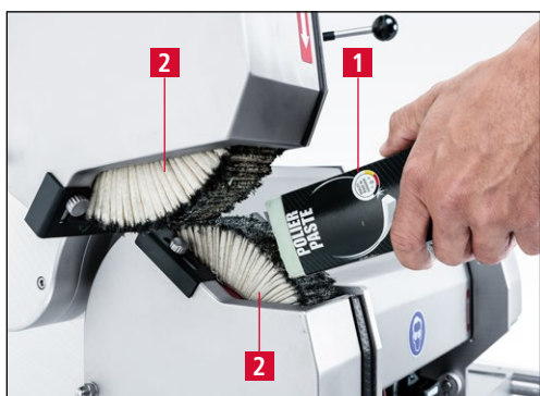
Figure 7-54 Application de pâte de polissage
