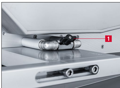
Figure 3-5 Dispositif doseur de liquide de refroidissement pour bande d'affûtage à eau
