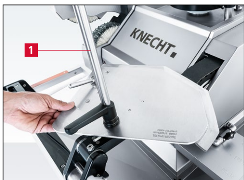
Figure 7-135 Pivoter le couteau de cutter sur le segment de coupe suivant et l'affûter
