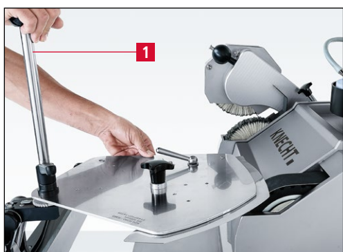
Figure 7-68 Pivoter le couteau de cutter sur le segment de coupe suivant et l'affûter
