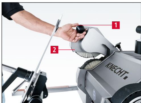
Figure 7-131 Mise en position de travail de l'unité de polissage supérieure
