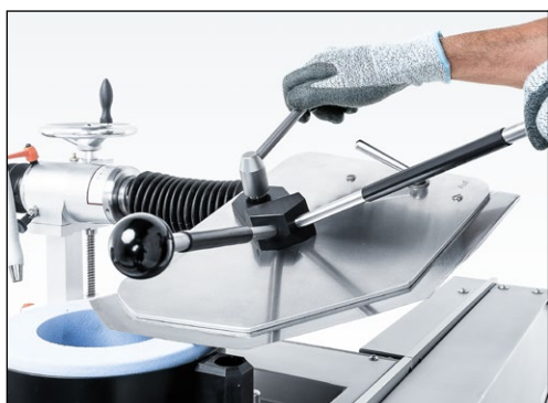
Figure 7-85 Alignement du couteau sur le disque d'affûtage
