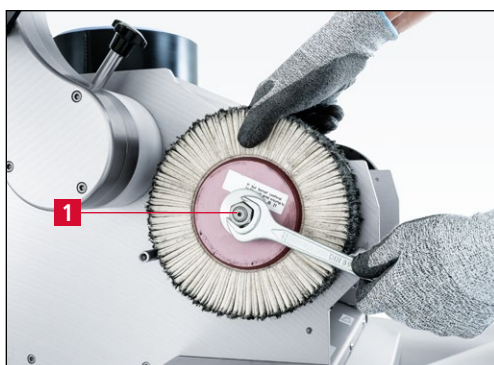
Figure 7-152 Remplacement de la brosse à lamelles
