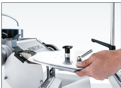
Figure 7-62 Polissage du bombage du couteau
