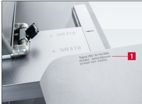
Figure 7-95 Rayon d'affûtage affiché sur le plateau d'affûtage SP 107
