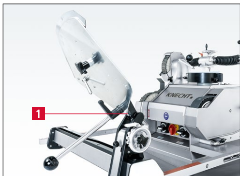
Figure 7-63 Couteau en dehors de la zone de polissage en position sécurisée
