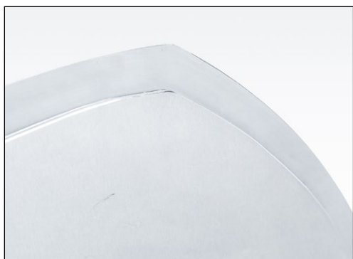
Figure 7-67 Contrôle de l'affûtage du couteau
