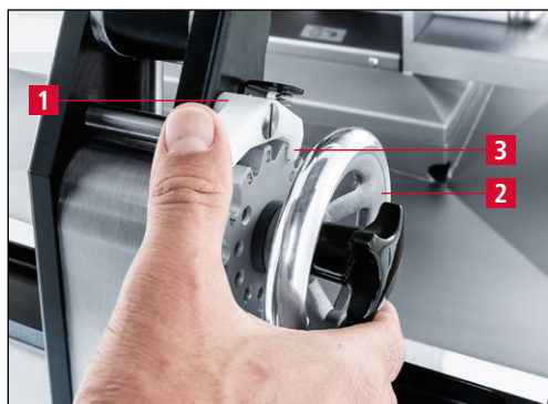
Figure 7-49 Pivotement de l'affûteuse en position d'affûtage «1»
