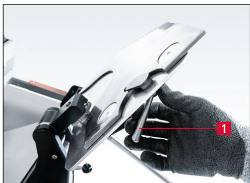
Figure 7-107 Blocage du couteau sur le plateau d'affûtage
