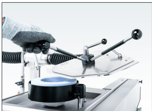
Figure 7-81 Pivoter le plateau d'affûtage vers l'avant
