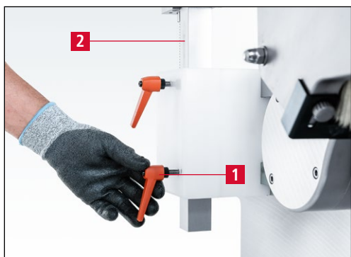
Figure 7-83 Réglage du couteau au centre du disque d'affûtage
