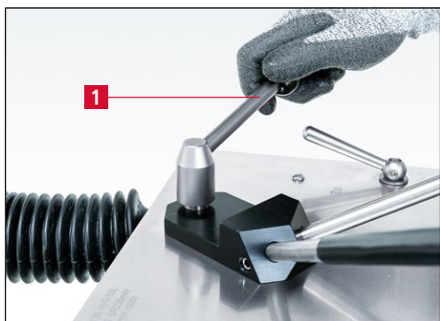
Figure 7-86 Serrage du levier de serrage
