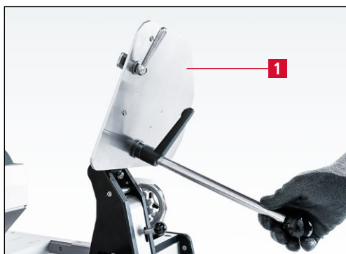
Figure 7-105 Pivoter le plateau d'affûtage vers l'arrière
