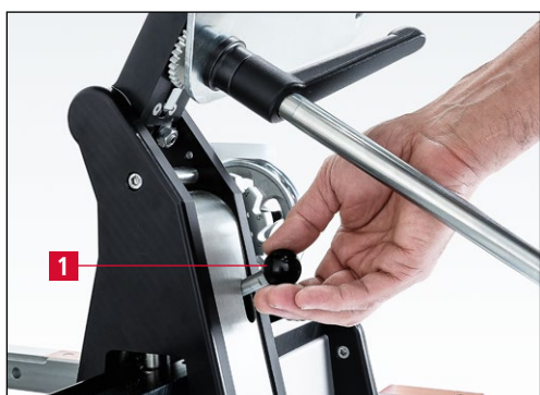
Figure 7-56 Ouverture du blocage sur le chariot
