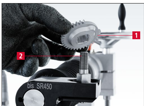
Figure 7-7 Montage de la rondelle fonctionnelle
