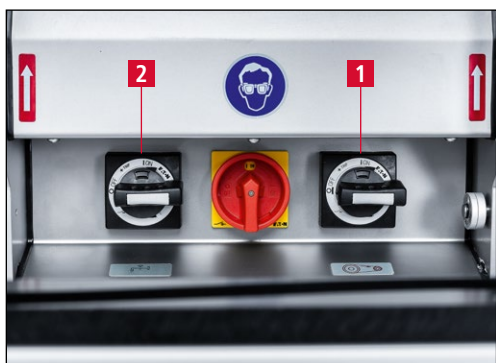
Figure 7-89 Mise en marche du moteur d'affûtage et du dispositif d'arrosage
