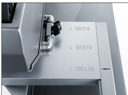
Figure 7-28 Position réglée de l'affûteuse-polisseuse
