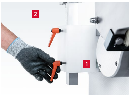
Figure 7-20 Réglage du couteau sur le disque d'affûtage
