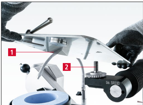
Figure 7-75 Monter le plateau d'affûtage
