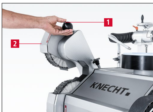
Figure 7-137 Unité de polissage supérieure en position de repos
