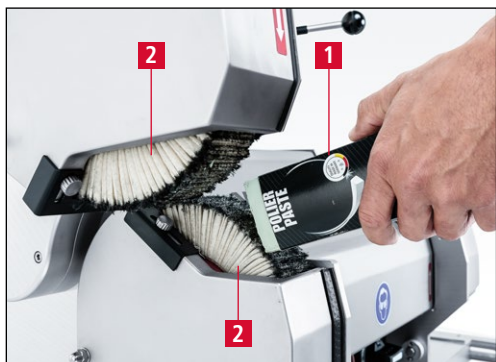
Figure 7-122 Application de pâte de polissage
