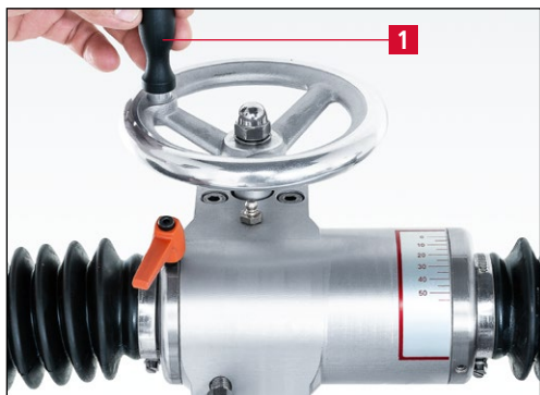
Figure 7-91 Réduction de l'angle d'affûtage (affûtage bombé)
