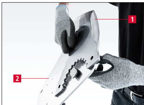
Figure 7-41 Serrage du couteau sur le plateau d'affûtage
