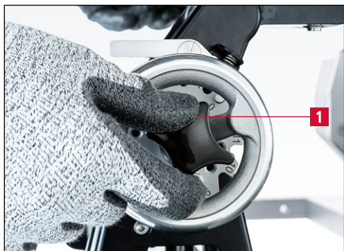
Figure 7-111 Desserrer la poignée étoile
