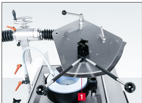
Imagen 7-19 Posición de la cuchilla en la muela de rectificado
