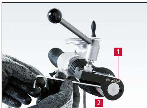
Imagen 7-70 Montaje del cabezal de alojamiento
