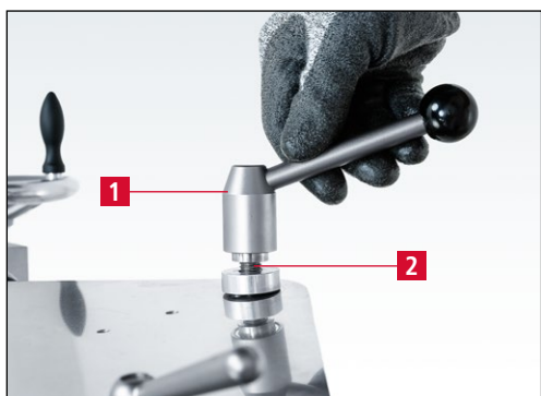
Imagen 7-12 Bloqueo de la placa de afilado
