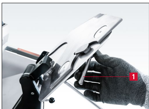
Imagen 7-107 Bloqueo de la cuchilla en la placa de afilado
