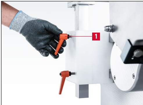
Imagen 7-87 Cómo soltar la palanca de sujeción
