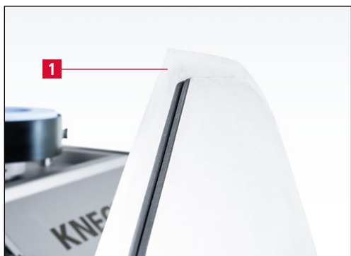
Imagen 7-134 Comprobación del afilado de cuchilla
