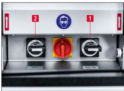
Imagen 7-89 Cómo encender el motor de la rectificadora y el sistema de refrigerante
