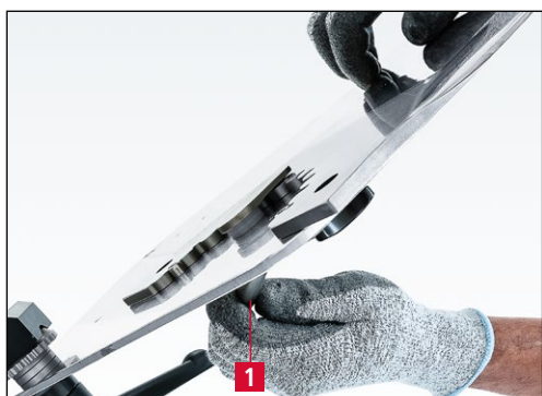
Imagen 7-42 Bloqueo de la cuchilla en la placa de afilado
