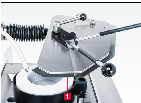
Imagen 7-82 Posición de la cuchilla en la muela de rectificado
