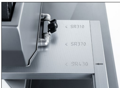
Imagen 7-28 Posición ajustada del dispositivo de afilado y pulido
