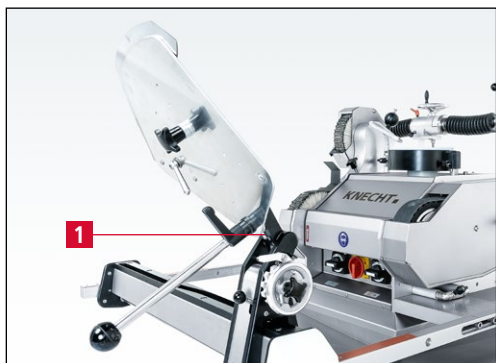
Imagen 7-63 Cuchilla fuera de la zona de pulido en posición bloqueada
