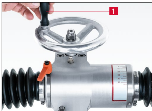
Imagen 7-91 Reducción del ángulo de afilado (afilado convexo)
