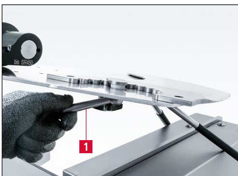
Imagen 7-18 Bloqueo de la cuchilla en la placa de afilado
