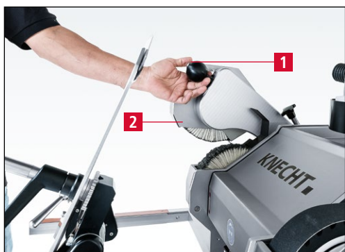
Imagen 7-131 Cómo poner la unidad de pulido superior en posición de trabajo
