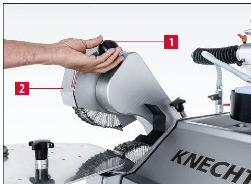
Imagen 7-60 Giro de la unidad de pulido superior hacia arriba
