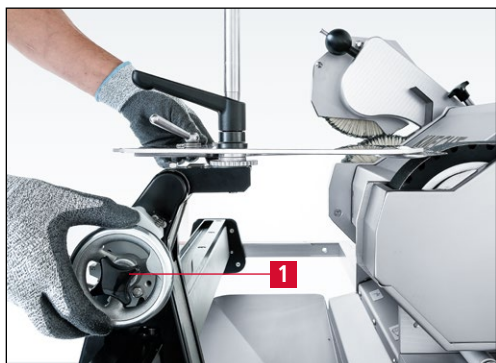
Imagen 7-112 Movimiento del equipo de afilado hacia la cinta de afilado
