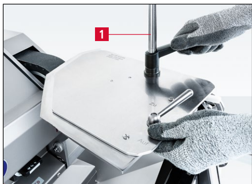
Imagen 7-115 Apriete de la palanca de afilado
