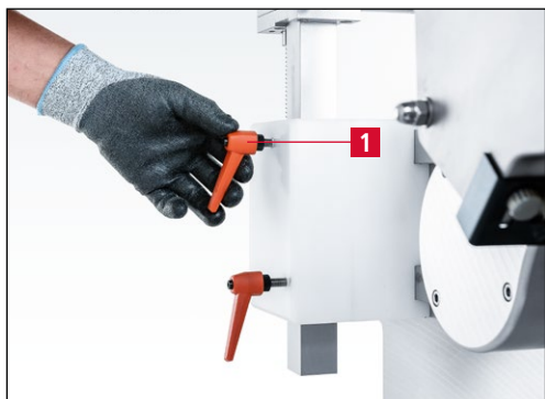
Imagen 7-21 Cómo soltar la palanca de sujeción
