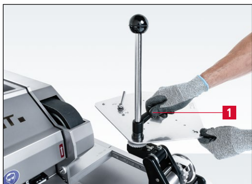
Imagen 7-39 Ajuste del radio de giro
