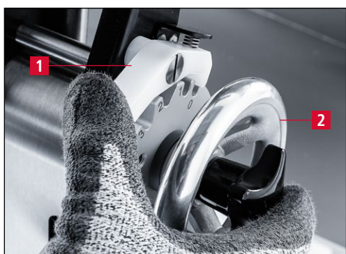
Imagen 7-110 Cómo poner el equipo de afilado en la posición de ajuste «0»
