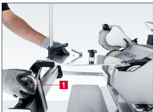
Imagen 7-47 Movimiento del equipo de afilado hacia la cinta de afilado
