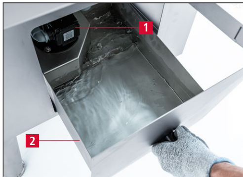
Imagen 3-10 Sistema de refrigerante
