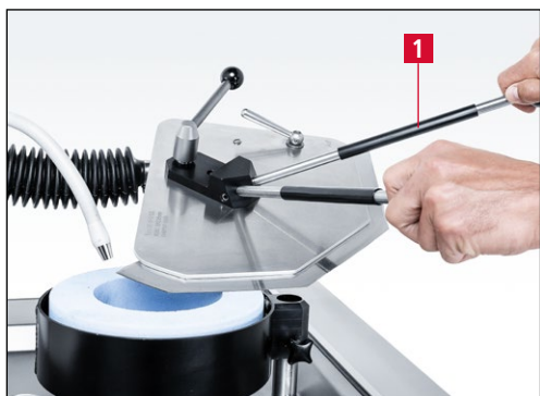
Imagen 7-90 Afilado de cúter lineal
