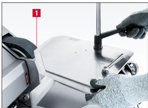
Imagen 7-114 Alineación de la cuchilla en la cinta de afilado
