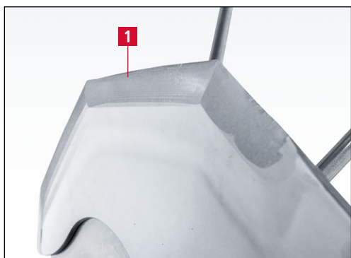
Imagen 7-93 Cúter con preafilado convexo
