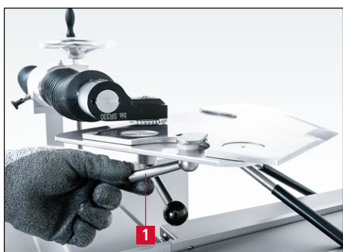
Imagen 7-80 Bloqueo de la cuchilla en la placa de afilado
