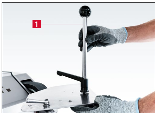
Imagen 7-104 Sujeción de la placa de afilado
