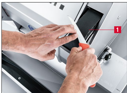
Imagen 7-136 Afilado de cuchillos
