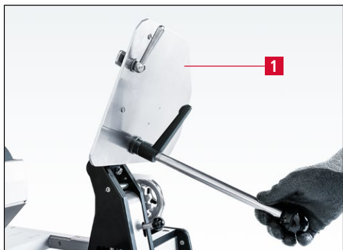
Imagen 7-105 Giro de la placa de afilado hacia atrás
