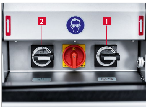
Imagen 7-141 Encendido de la rectificadora
