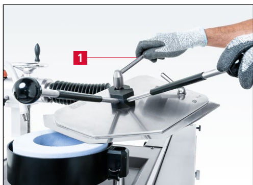
Imagen 7-84 Cómo aflojar la palanca de apriete
