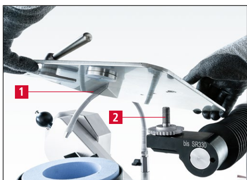
Imagen 7-75 Montaje de la placa de afilado
