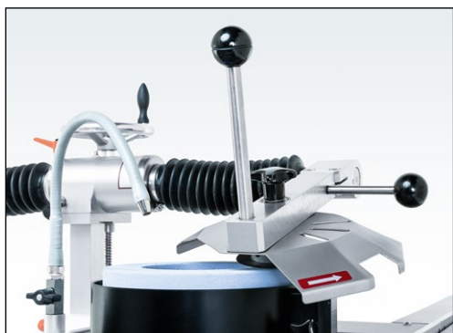
Imagen 7-155 Dispositivo de afilado de cuchillas circulares HV 25-1
