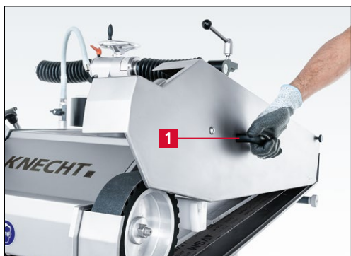
Imagen 7-146 Apertura de la cubierta de protección de la cinta
