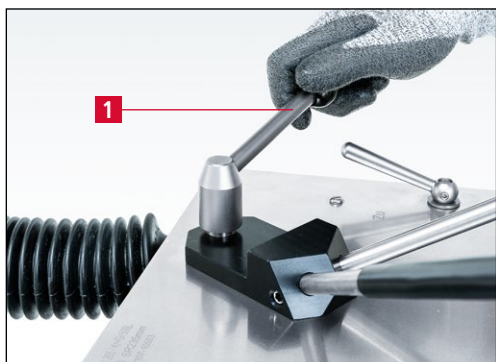
Imagen 7-86 Fijación de la palanca de apriete
