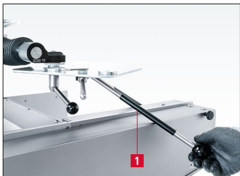
Imagen 7-78 Giro de la placa de afilado hacia atrás
