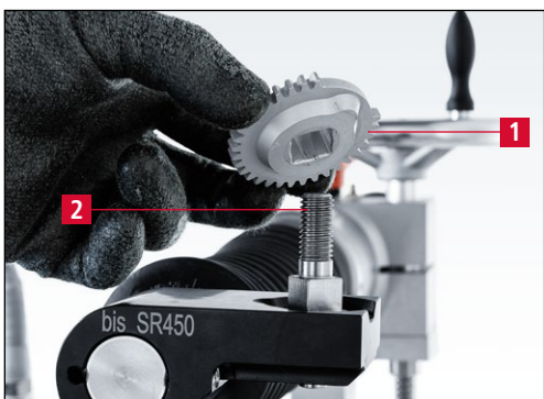
Imagen 7-7 Cómo insertar el disco funcional
