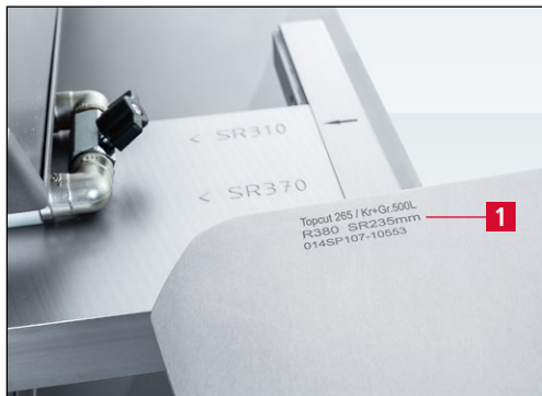
Imagen 7-95 Radio de afilado indicado en la placa de afilado SP 107
