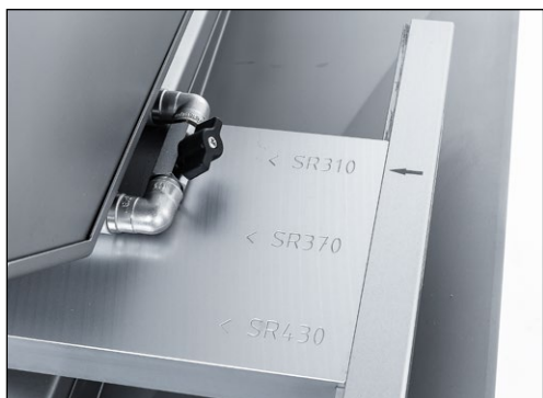
Imagen 7-94 Posición ajustada del dispositivo de afilado y pulido
