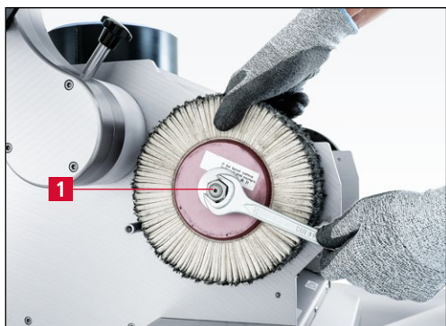
Imagen 7-152 Cambio del cepillo laminar inferior
