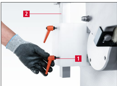
Imagen 7-83 Ajuste de la cuchilla en el centro de la muela de rectificado
