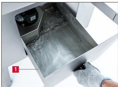
Imagen 6-1 Cómo rellenar el depósito de agua
