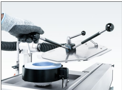
Imagen 7-81 Giro de la placa de afilado hacia delante
