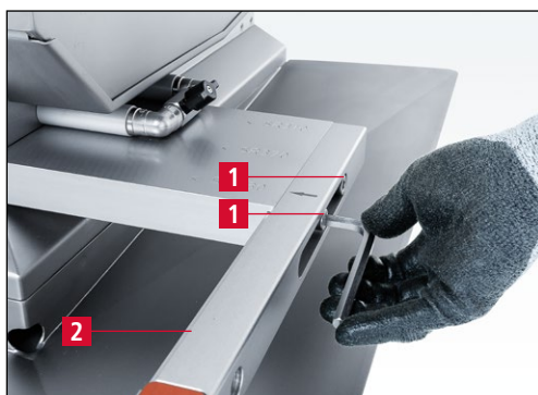
Imagen 7-96 Cómo aflojar tornillos M 10
