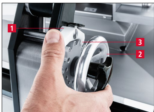
Imagen 7-117 Poner el equipo de afilado en la posición de afilado «1»
