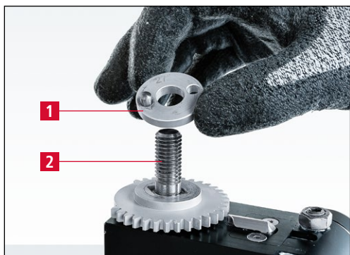
Imagen 7-36 Ajuste del ángulo de afilado
