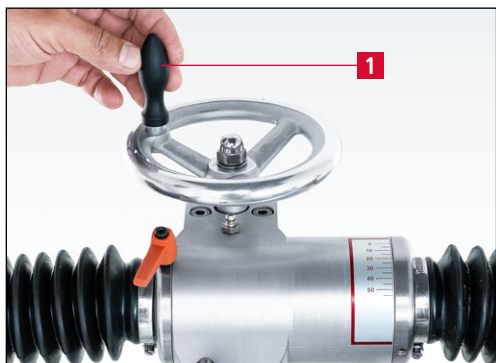
Imagen 7-25 Reducción del ángulo de afilado (afilado convexo)
