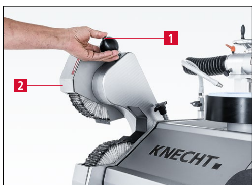
Imagen 7-64 Cómo poner la unidad de pulido superior en posición de trabajo
