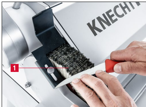
Imagen 7-138 Desbarbado y pulido de cuchillos
