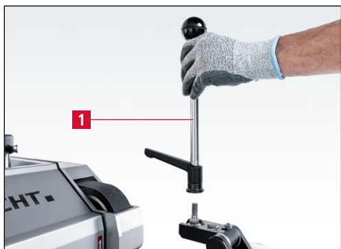
Imagen 7-99 Cómo retirar la palanca de afilado
