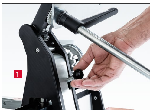
Imagen 7-56 Apertura del sistema de bloqueo del patín de guía
