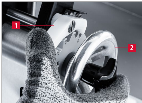
Imagen 7-45 Cómo poner el equipo de afilado en la posición de ajuste «0»
