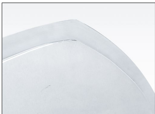
Imagen 7-67 Comprobación del afilado de cuchilla
