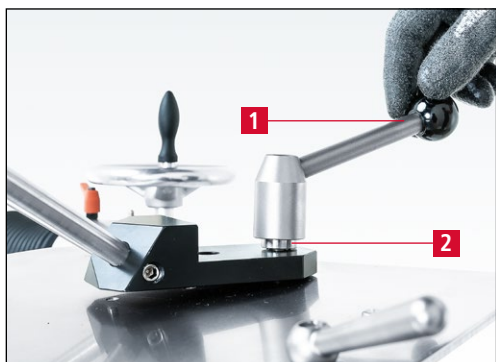
Imagen 7-77 Bloqueo de la placa de afilado
