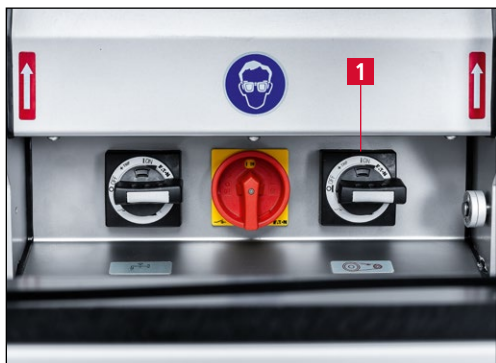
Imagen 7-66 Apagado de la rectificadora
