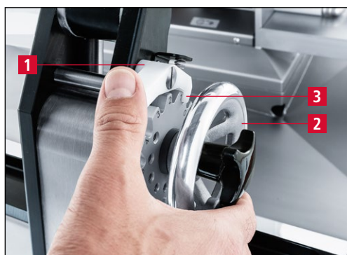
Imagen 7-49 Cómo poner el equipo de afilado en la posición de afilado «1»
