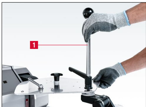
Imagen 7-38 Apriete de la palanca de afilado
