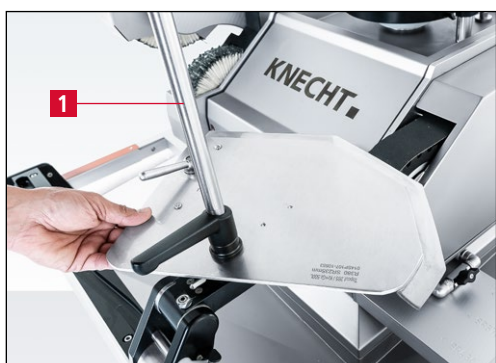
Imagen 7-135 Girar el cúter hasta el siguiente segmento del filo y afilar
