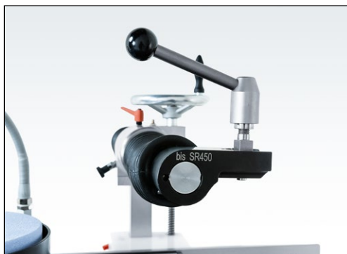
Imagen 7-1 Comprobación de la posición del cabezal de alojamiento
