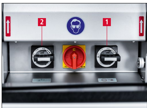
Imagen 7-116 Cómo encender el motor de afilado y el sistema de refrigerante
