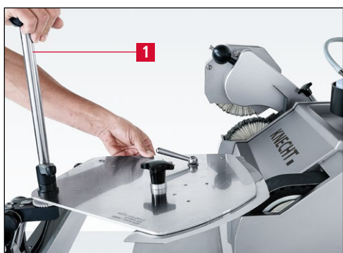
Imagen 7-68 Girar el cúter hasta el siguiente segmento del filo y afilar
