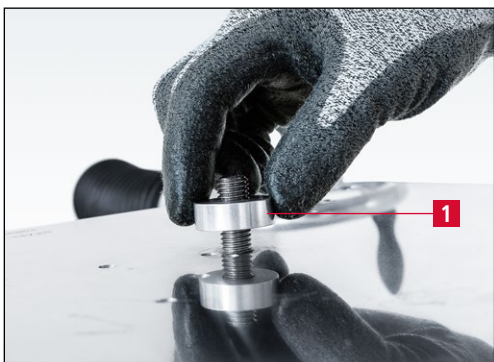
Imagen 7-10 Cómo retirar la arandela de separación
