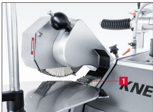
Imagen 7-124 Cuchilla situada sobre el cepillo laminar
