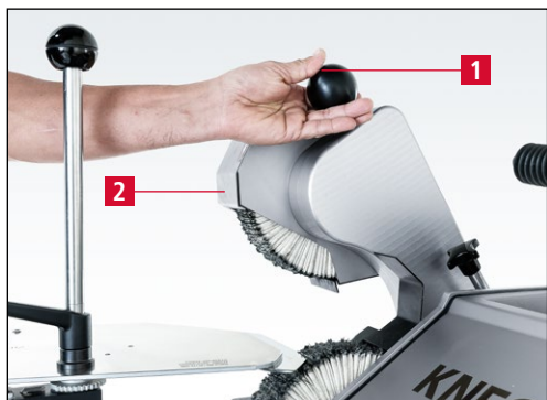
Imagen 7-127 Giro de la unidad de pulido superior hacia arriba
