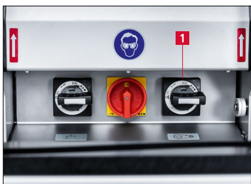
Imagen 7-128 Encendido del motor de la rectificadora
