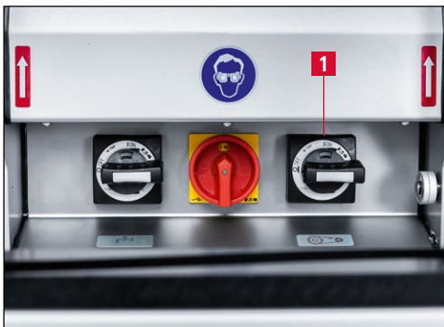
Imagen 7-61 Encendido de la rectificadora
