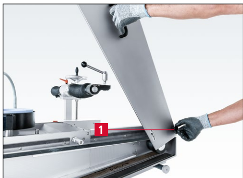
Imagen 7-149 Cierre de la cubierta de protección de la cinta
