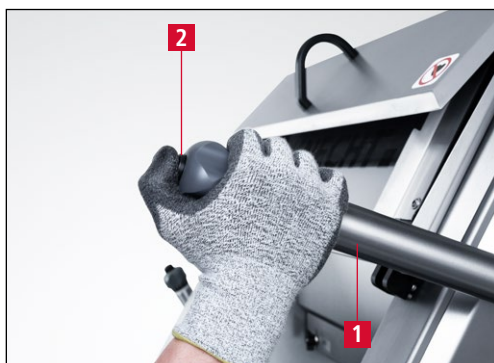
Kuva 7-39 Hiomayksikön liikuttaminen ylöspäin
