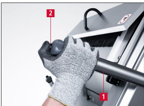
Kuva 7-12 Hiomayksikön liikuttaminen ylöspäin
