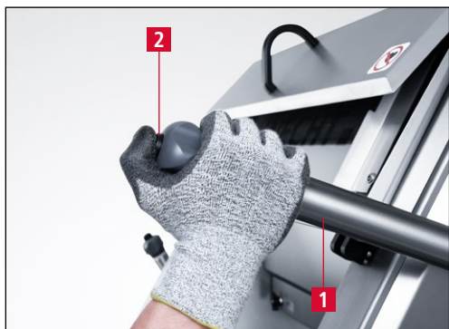
Kuva 7-26 Hiomayksikön liikuttaminen ylöspäin
