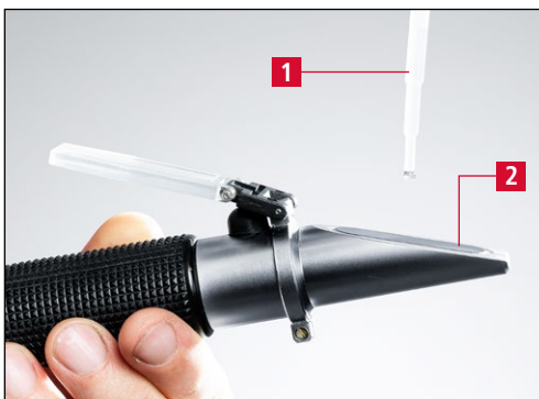
Kuva 8-11 Jäähdytysvoiteluaineen pitoisuuden mittaaminen
