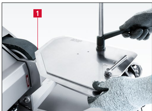
Rys. 7-114 Ustawianie noża na taśmie szlifierskiej
