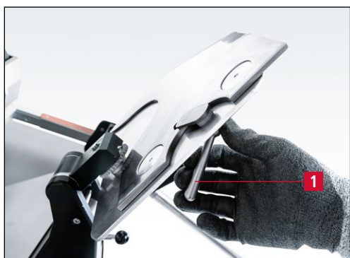
Rys. 7-107 Blokowanie noża na talerzu szlifierskim
