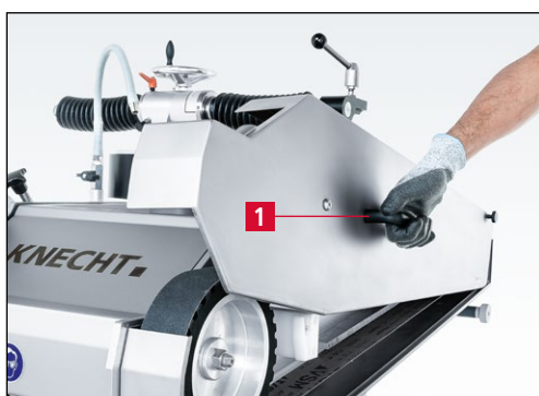
Rys. 7-146 Otwieranie pokrywy ochronnej taśmy
