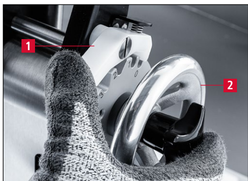
Rys. 7-45 Ustawianie urządzenia ostrzącego w pozycji „0”
