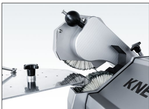
Rys. 7-58 Odległość pomiędzy szczotkami listkowymi ok. 20 mm
