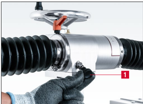
Rys. 7-73 Blokowanie sworznia ustalającego
