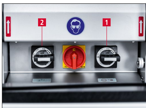
Rys. 7-89 Włączanie silnika szlifierki i systemu chłodzenia
