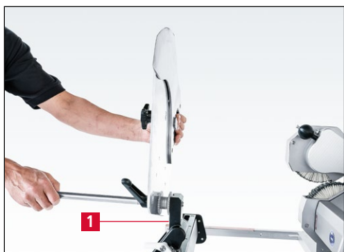
Rys. 7-52 Nóż kutrowy odchylony i zabezpieczony
