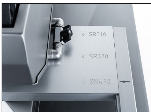
Rys. 7-28 Ustawiona pozycja urządzenia ostrzającego i polerującego
