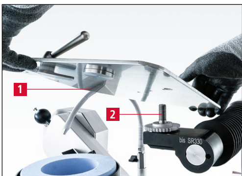
Rys. 7-75 Montaż talerza szlifierskiego
