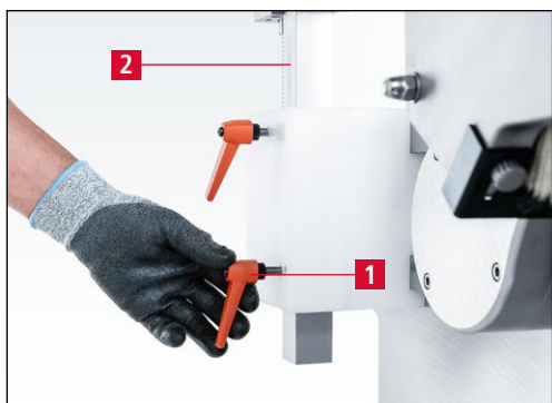
Rys. 7-83 Ustawianie noża na środku tarczy szlifierskiej
