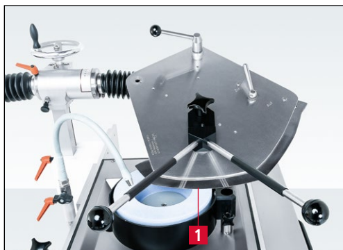
Rys. 7-19 Ułożenie noża na tarczy szlifierskiej
