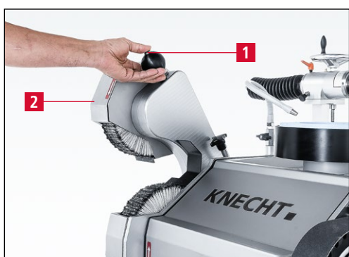
Rys. 7-137 Ustawianie górnej jednostki polerskiej w położeniu spoczynkowym
