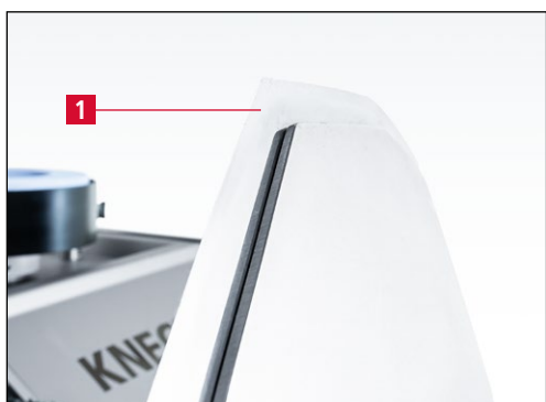
Rys. 7-134 Kontrola ostrości noża
