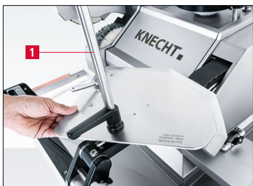
Rys. 7-135 Przesuwanie noża kutowego do następnego segmentu i szlifowanie
