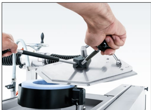
Rys. 7-92 Przesuwanie noża kutrowego do następnego segmentu i szlifowanie
