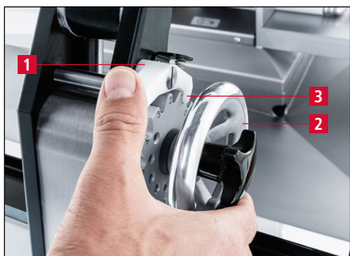
Rys. 7-117 Ustawianie urządzenia ostrzącego w pozycji szlifowania „1”
