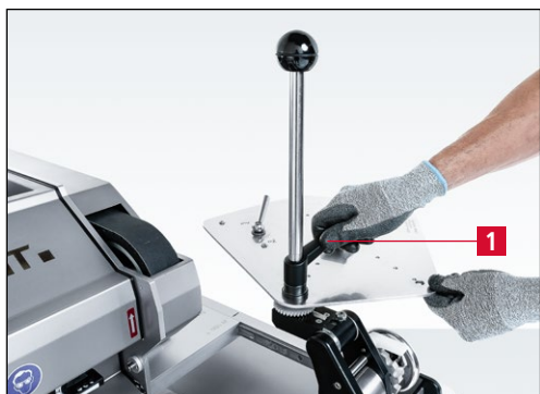
Rys. 7-39 Ustawianie zakresu odchylenia
