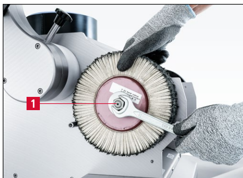
Rys. 7-152 Wymiana dolnej szczotki listkowej
