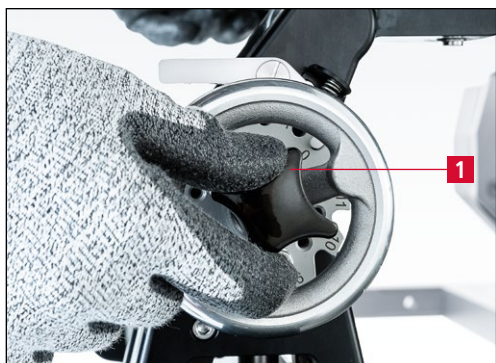
Rys. 7-111 Luzowanie uchwytu krzyżowego
