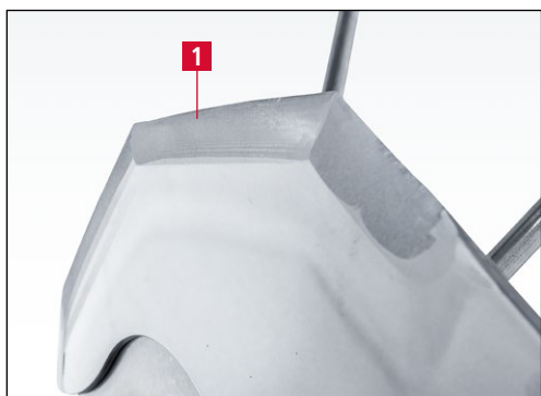
Rys. 7-93 Wstępnie oszlifowany nóż kulisty
