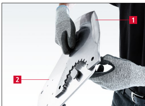
Rys. 7-41 Mocowanie noża na talarzu szlifierskim
