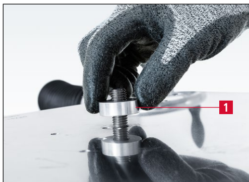
Rys. 7-10 Demontaż podkładki dystansowej
