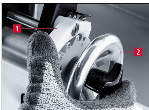
Rys. 7-110 Ustawianie urządzenia ostrzącego w pozycji „0”
