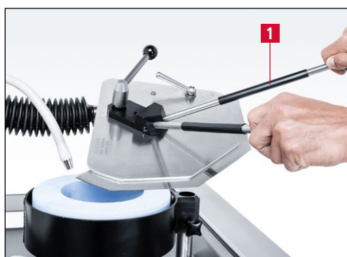
Rys. 7-90 Szlifowanie liniowego noża kutrowego
