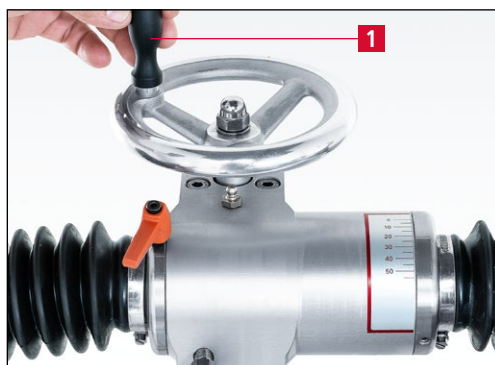
Rys. 7-91 Zmniejszanie kąta szlifowania (szlifowanie kulowe)
