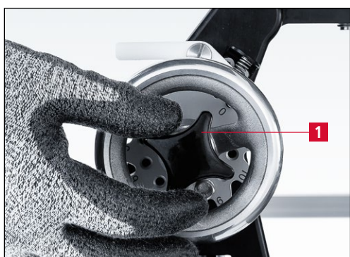
Rys. 7-46 Luzowanie uchwyty krzyżowego
