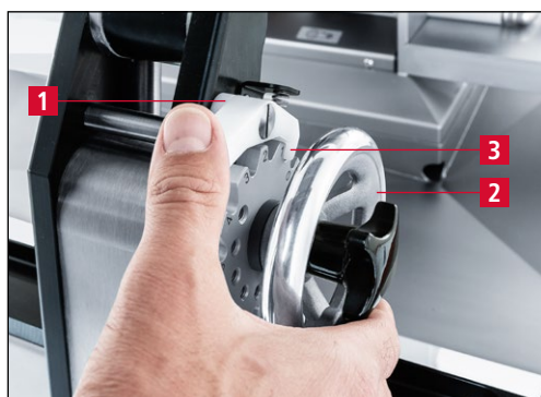
Rys. 7-49 Ustawianie urządzenia ostrzącego w pozycji szlifowania „1”
