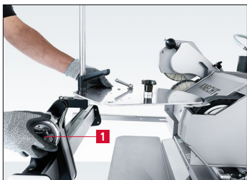
Rys. 7-47 Przesunięcie urządzenia ostrzącego do taśmy szlifierskiej
