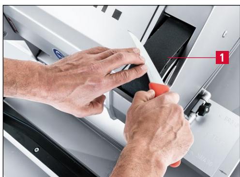
Rys. 7-136 Szlifowanie noży ręcznych
