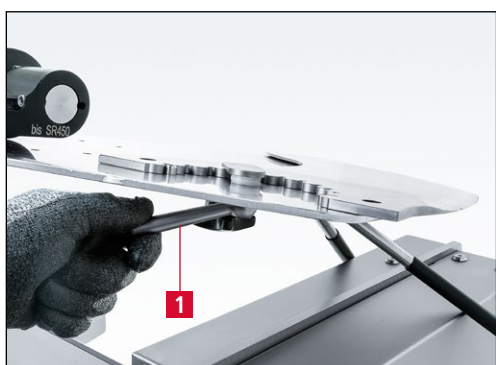
Rys. 7-18 Blokowanie noża na talerzu szlifierskim
