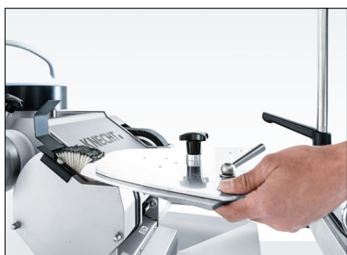
Rys. 7-62 Polerowanie brzośca noża
