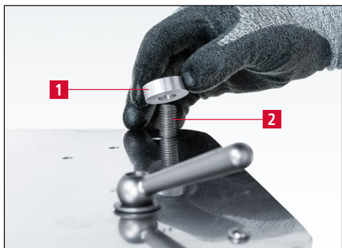
Rys. 7-11 Nakładanie podkładki dystansowej na trzpień mocujący
