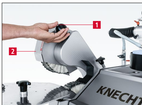
Rys. 7-60 Odchylanie górnej jednostki polerskiej
