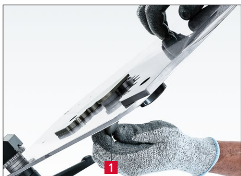
Rys. 7-42 Blokowanie noża na talarzu szlifierskim
