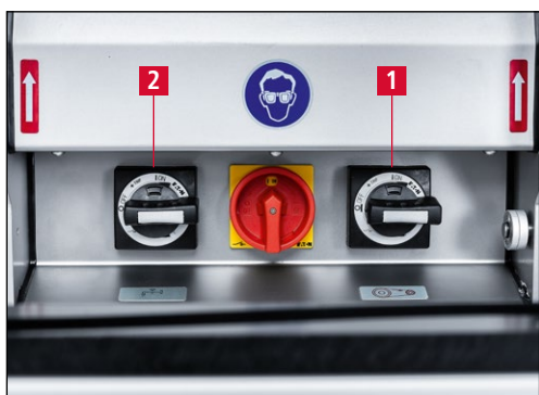
Rys. 7-116 Włączanie silnika szlifierki i systemu chłodzenia
