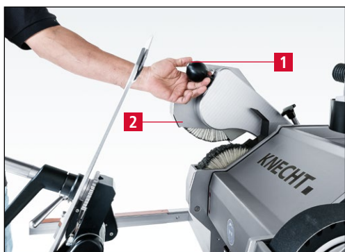
Rys. 7-131 Ustawianie górnej jednostki polerskiej w pozycji roboczej
