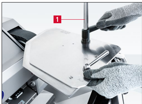
Rys. 7-115 Dokręcanie dźwigni szlifowania
