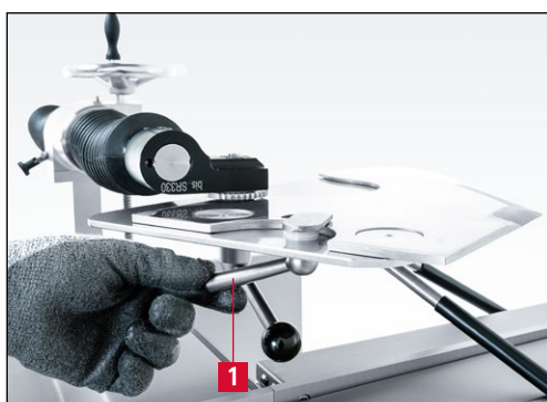
Rys. 7-80 Blokowanie noża na talerzu szlifierskim
