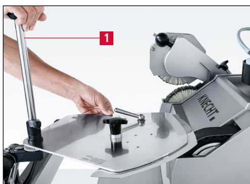
Rys. 7-68 Przesuwanie noża kutrowego do następnego segmentu i szlifowanie
