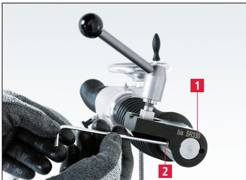
Slika 7-70 Vgradnja sprejemne glave
