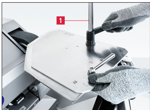
Slika 7-115 Privijanje brusilne ročice
