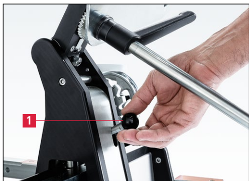
Slika 7-56 Odpiranje aretirnega mehanizma na vodilu s kolesci
