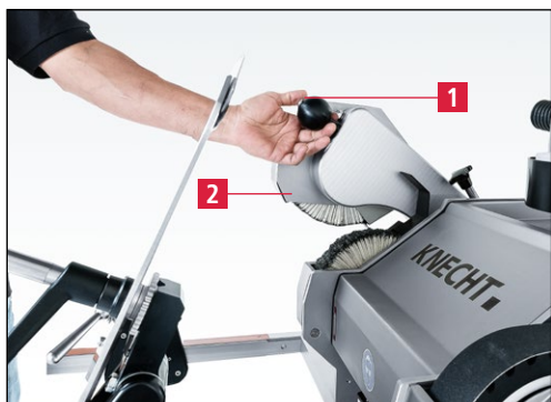
Slika 7-131 Postavite zgornjo polirno enoto v delovni položaj
