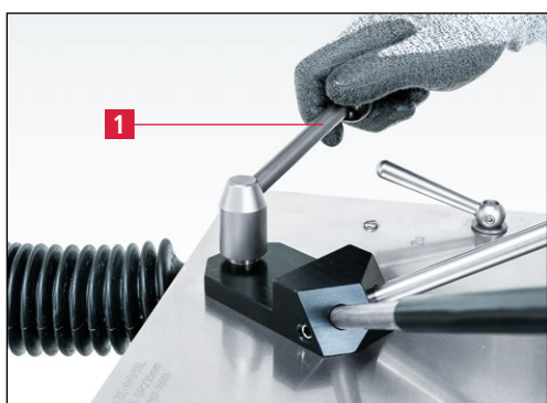
Slika 7-86 Privijanje vpenjalnega vzvoda
