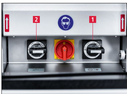
Slika 7-89 Vključitev brusilnega motorja in naprave za hladilno tekočino
