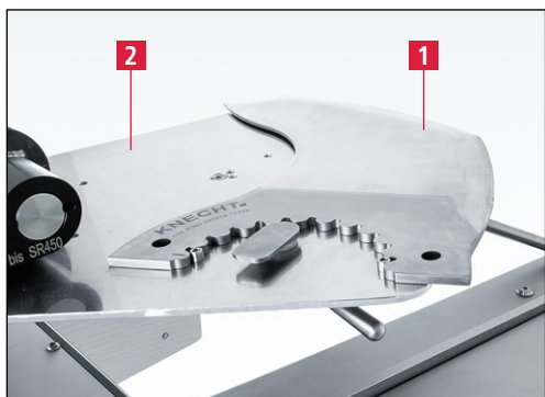
Slika 7-17 Vpenjanje nožev na brusilno ploščo
