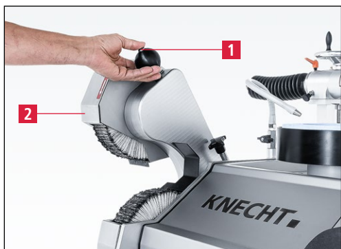
Slika 7-64 Postavite zgornjo polirno enoto v delovni položaj
