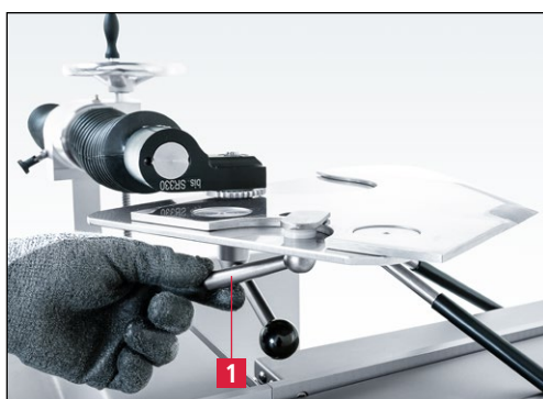
Slika 7-80 Blokiranje nožev na brusilni plošči
