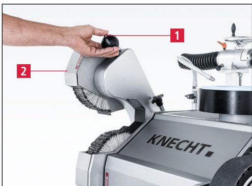
Slika 7-137 Postavite zgornjo polirno enoto v položaj mirovanja
