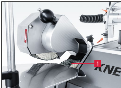
Slika 7-124 Rezilo leži na lamelni krtači
