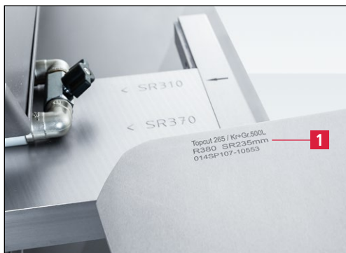
Slika 7-95 Prikazan polmer brušenja na brusilni plošči SP 107
