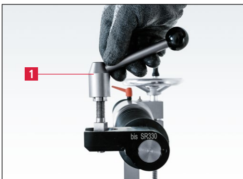
Slika 7-71 Odstranjevanje vpenjalnega vzvoda
