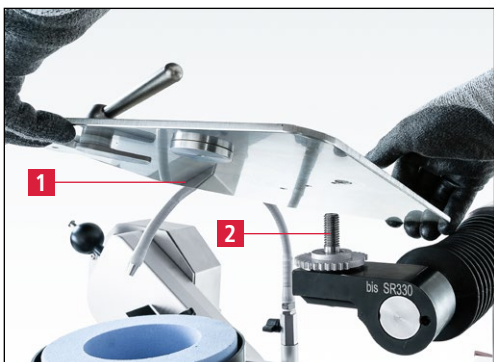
Slika 7-75 Vgradnja brusilne plošče
