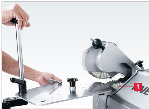
Slika 7-57 Nož leži na lamelni krtači
