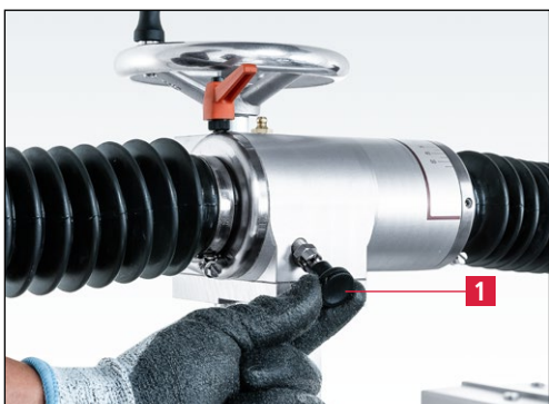
Slika 7-73 Namestitev zaskočnega sornika
