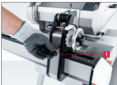
Slika 7-33 Zaklepanje vodila s kolesci
