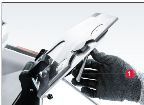
Slika 7-107 Blokiranje nožev na brusilni plošči
