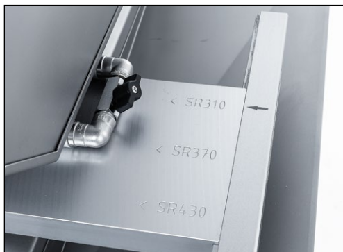
Slika 7-94 Nastavljen položaj brusilne in polirne naprave
