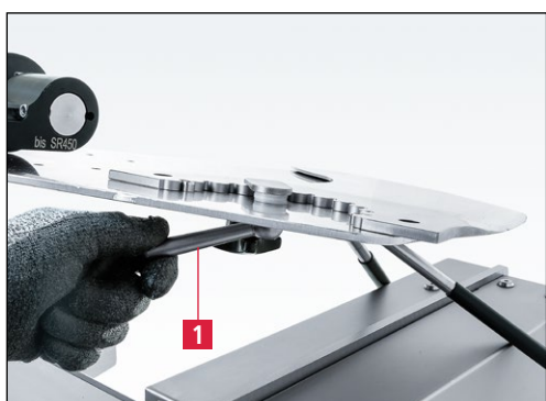
Slika 7-18 Blokiranje nožev na brusilni plošči
