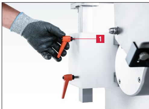
Slika 7-21 Sprostitev vpenjalne ročice
