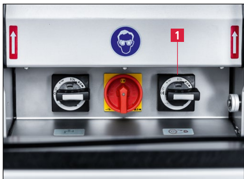
Slika 7-133 Izklop brusilnega motorja
