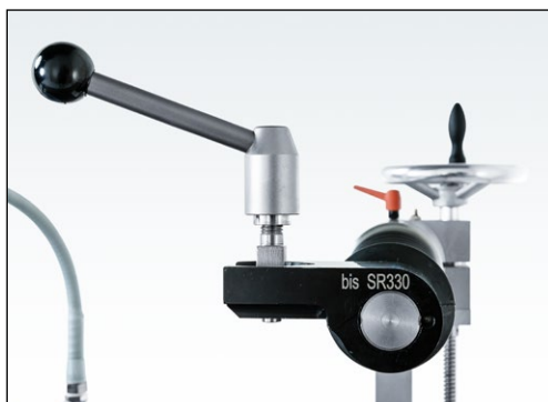
Slika 7-69 Preverjanje položaja sprejemne glave
