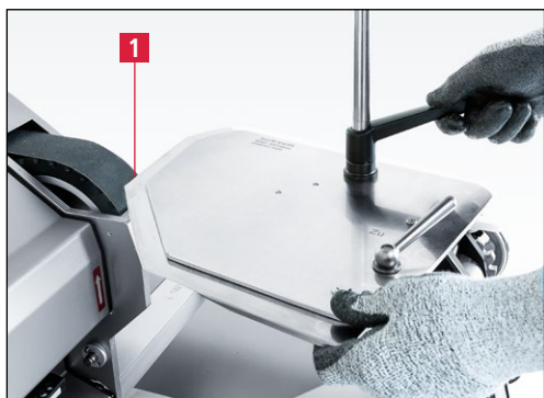
Slika 7-114 Poravnava noža z brusnim trakom
