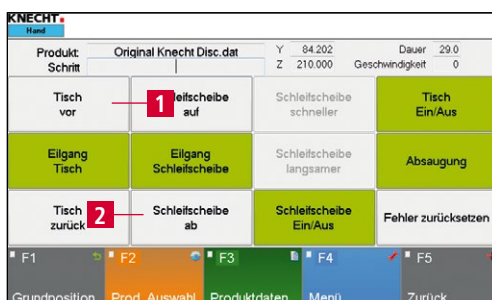
Bild 8-15 Tisch und Schleifscheibe in Arbeitsposition bringen
