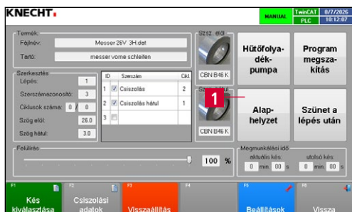
7-7. ábra Ívtárcsa cserepozícióba mozgatása
