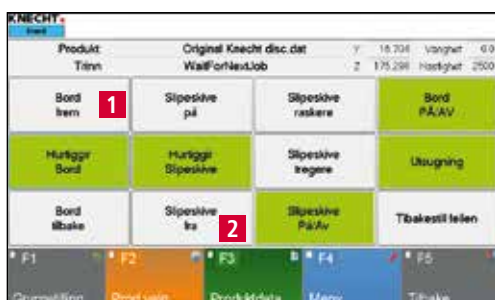
Figur 8-15 Bringe bord og slipeskive i arbeidsposisjon
