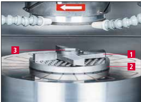
Bild 7-6 Sliping av "propell"-kniver
