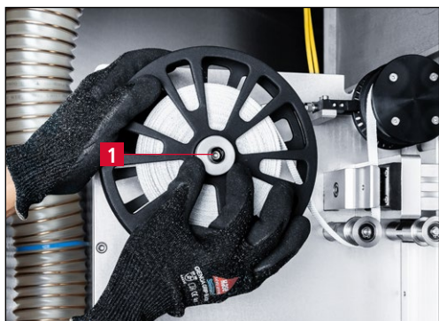
Fig. 7-62 Brugt testmedium fjernes
