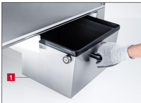
Fig. 9-2 Udsugningsanlæggets skuffe tømmes
