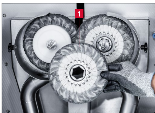
Fig. 7-47 Brugt poleringsring fjernes
