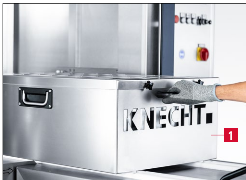
Kuva 9-14 Tyhjän veitsimakasiinin työntäminen koneeseen
