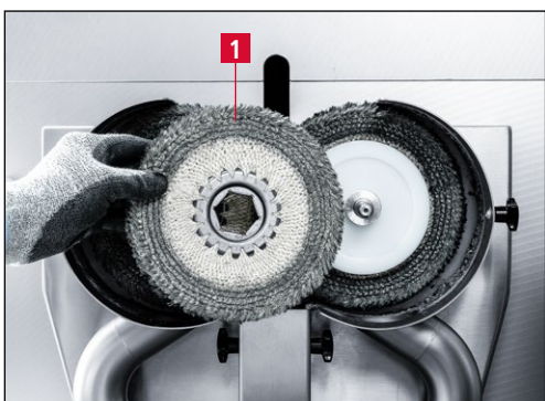
Kuva 7-30 Käytetyn purseenpoistorengaan irrottaminen
