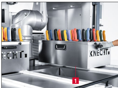
Kuva 7-4 Veitsimakasiinien työntäminen hiomakoneeseen
