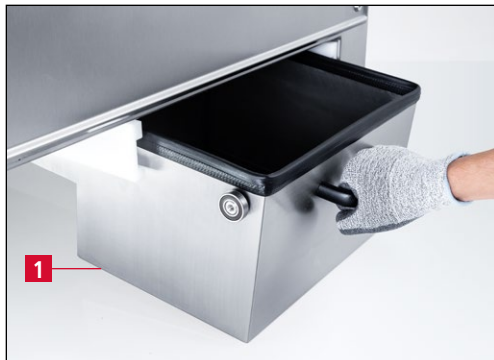
Kuva 9-2 Imujärjestelmän laatikon tyhjentäminen
