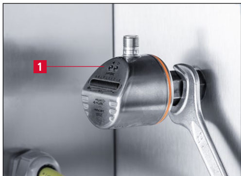
Kuva 9-7 Virtauksen valvontalaitteen kiertäminen ulos
