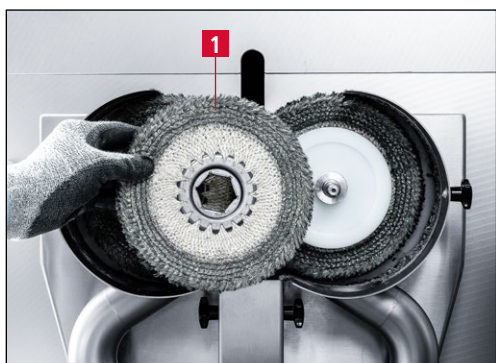
Bild 7-30 Ta bort den begagnade avgradningsringen
